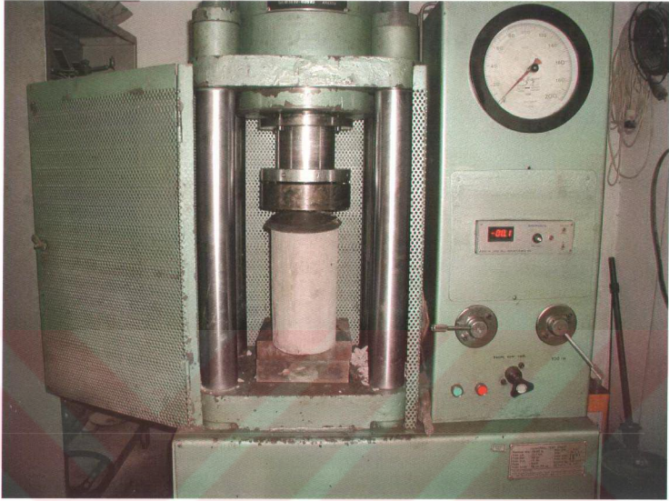
Şekil 4.23. Beton silindir deneyi
