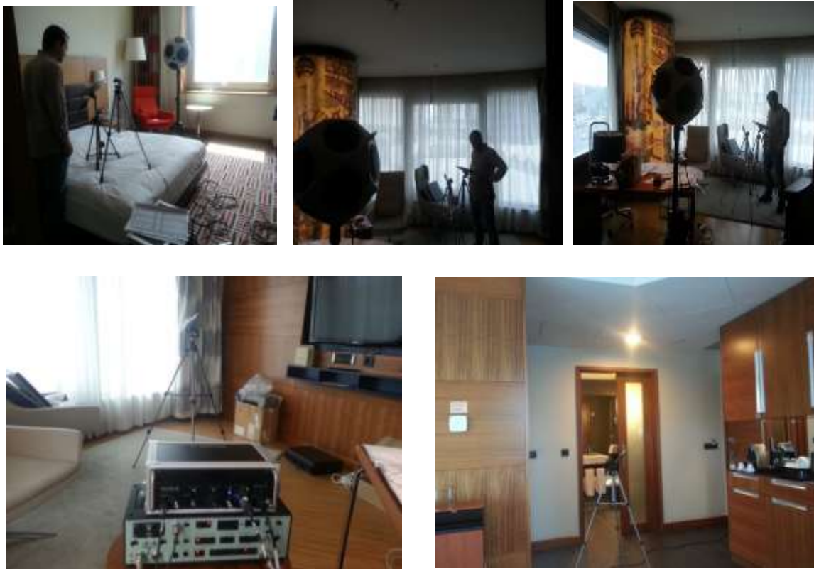
Resim 4.5. Yapı elemanları ses geçiş kaybının hesaplanması için akustik ölçümler
