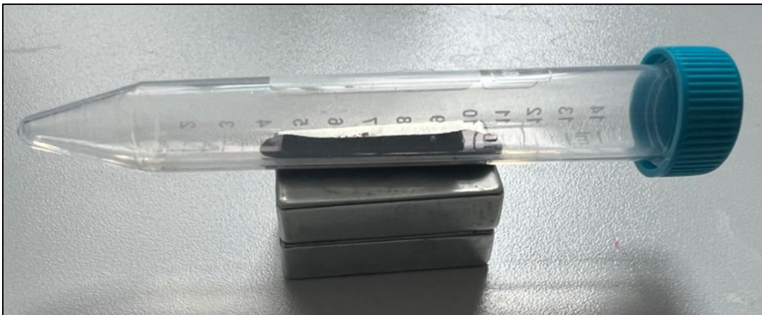
Resim 3.7. Mıknatıs yardımıyla manyetik katı-faz adsorbanının sıvı kısımdan ayrılması
