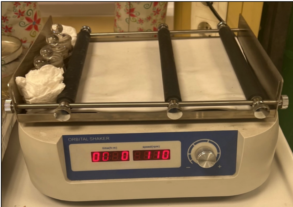
Resim 3.5. Yüzeyin APTES'le kaplanması sırasında kullanılan orbital karıştırıcı
