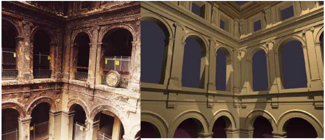
Resim 3.9. Röleve fotogrametrisinin vektörel çizim haline getirilmesi
