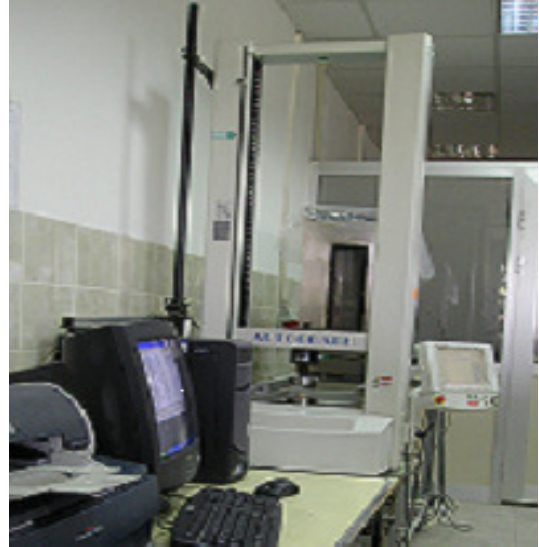
Resim 3.5. Basma deneylerinde kullanılan test cihazı
