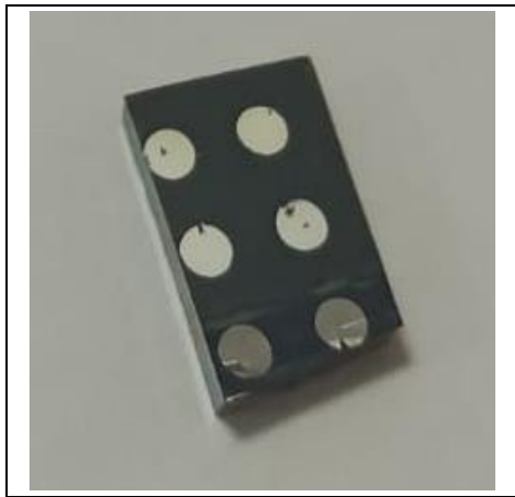
Resim 4.1. CTS 1112-40 dk kodlu ince film güneş hücresinin görseli
