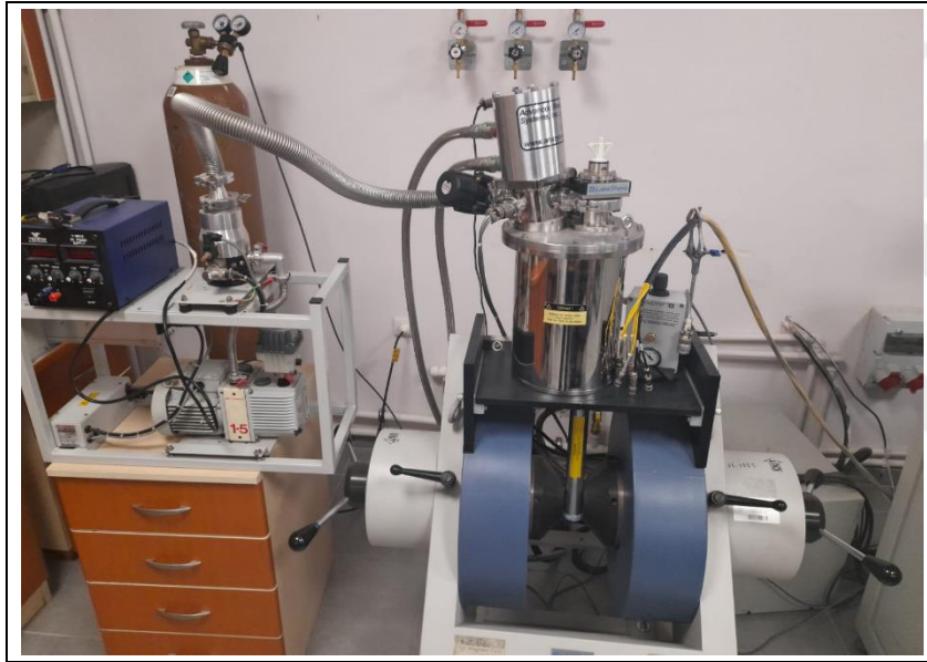
Resim 3.6. Lakeshore 7700 serisi Yüksek Empedans Hall etkisi ölçüm sistemi
