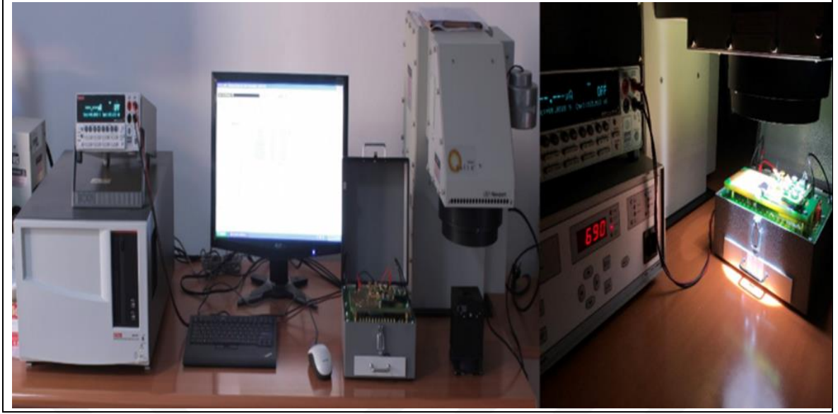
Resim 3.10. Akım-gerilim ölçüm sistemi
