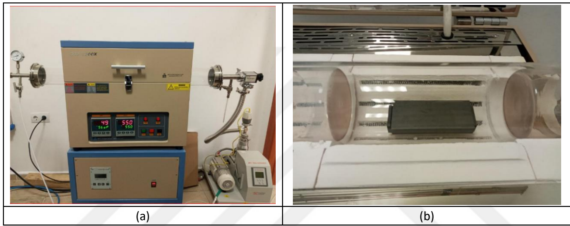
Resim 3.11. Sülfürizasyon sürecinde kullanılan (a) vakumlu difüzyon fırını ve (b) grafit kutu
