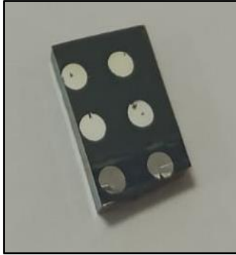
Resim 3.14. CTS ince film güneş hücreleri ( CTS1112-40dk.)
