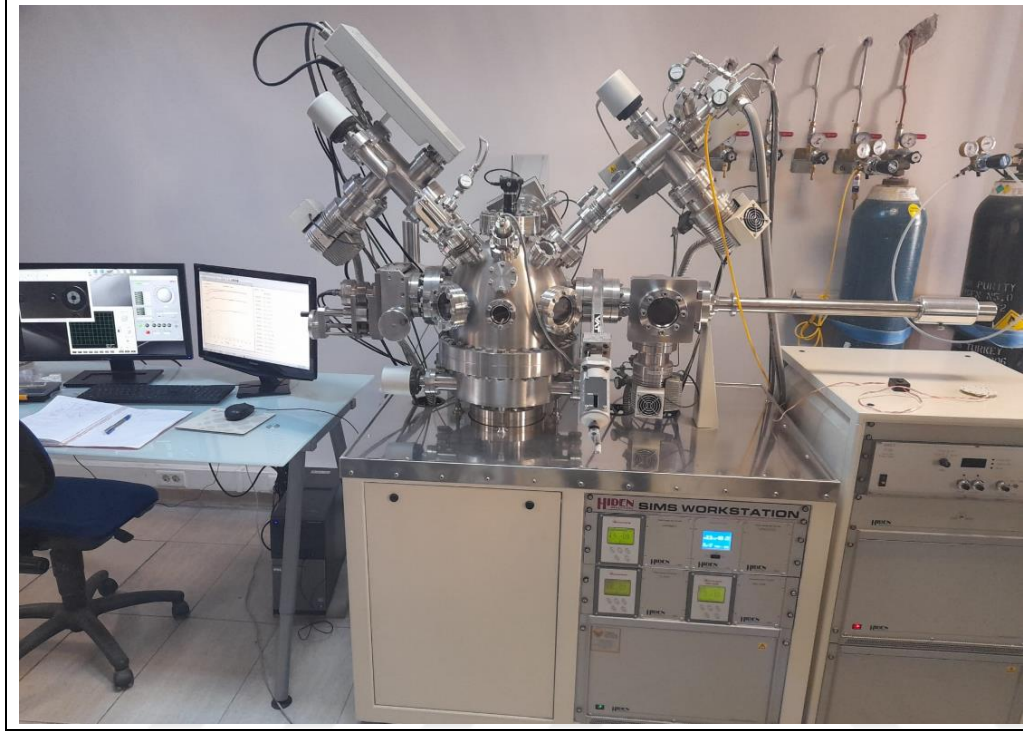
Resim 3.8. İkincil iyon kütle spektroskopisi sistemi
