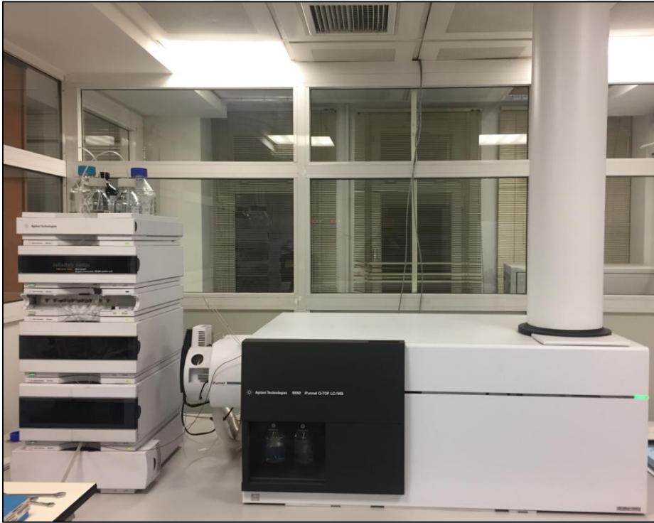
Resim 3.5. Fakültemizde bulunan Agilent 6550 iFunnel Q-TOF cihazı
