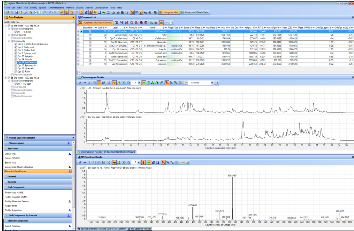
Şekil 4.2. LC-Q-ToF cihazında EB etanol ekstresine ait ekstrakte iyon kromatogramı ile MS spektrumu analizi için yapılan kütüphane ön taraması
