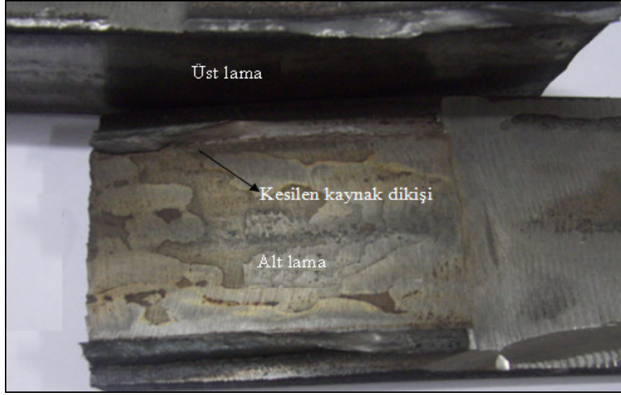
Resim 8.4. 148 N/mm 2 öngerilme uygulanan numunenin çekme/makaslama testi sonrası kaynak dikişlerinin ve kopma bölgelerinin görüntüsü
