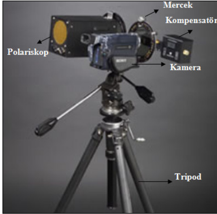
Resim 7.4. Fotoelastisite ölçüm cihazı
