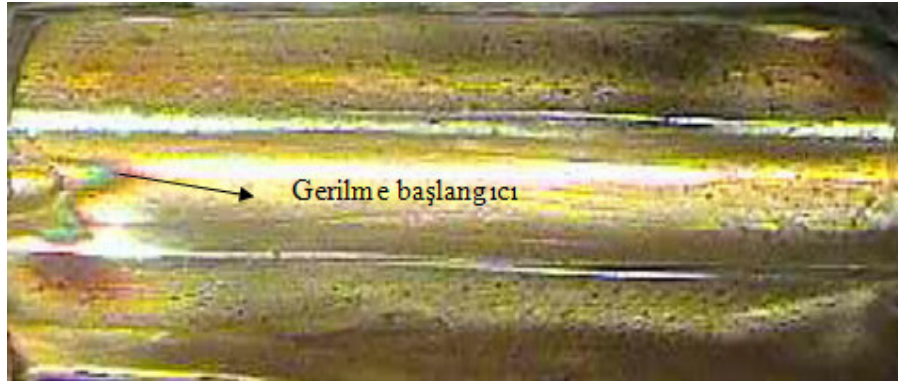
Resim 8.8. 25 kN'luk yük uygulandığında kaynak dikişinde oluşan gerilme dağılımı
