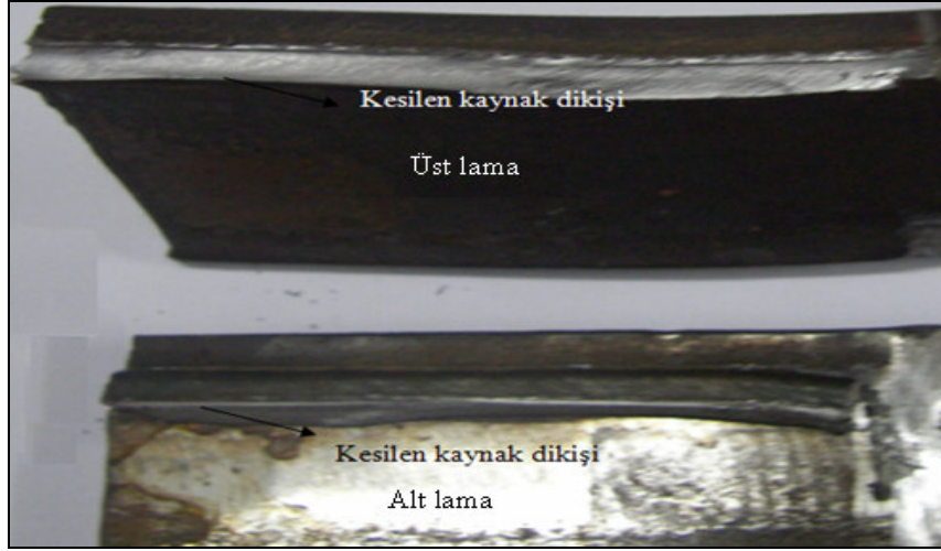
Resim 8.6. 222 N/mm 2 öngerilme uygulanan numunenin çekme/makaslama testi sonrası kaynak dikişlerinin ve kopma bölgelerinin görüntüsü
