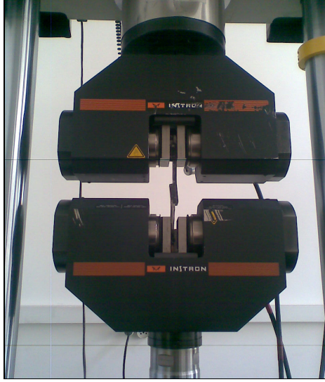
Resim 7.7. Kalıcı gerilmeli kaynaklı birleştirmelerin çekme deneyi
