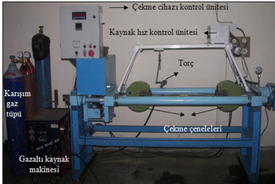
Resim 7.2. Yatay çekme deney cihazı ve kaynak ünitesi
