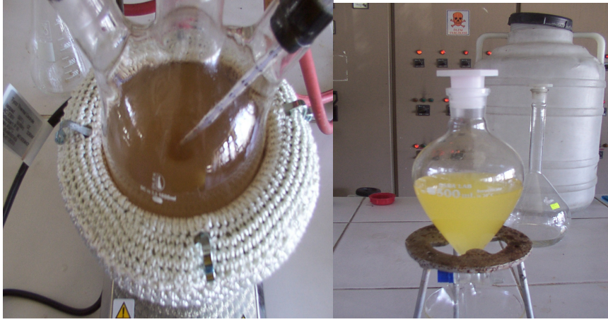
Resim 3.3. Metil alkol-sodyum hidroksit karışımı – ester fazı reaksiyonu ve ayırma hunisinde ayrılması
