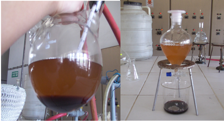
Resim 3.2. Reaksiyon sonunda oluşan gliserin fazı ve ayırma hunisinde ayrılması
