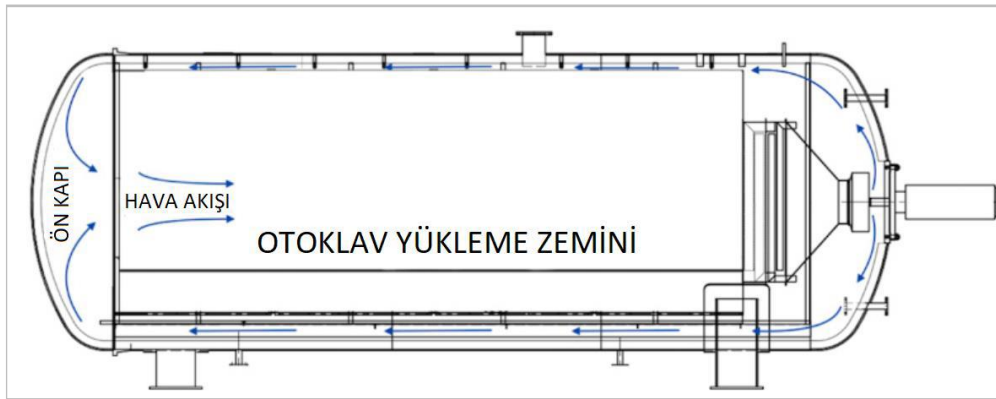
Şekil 2.17. Otoklav şematik gösterimi [30]
