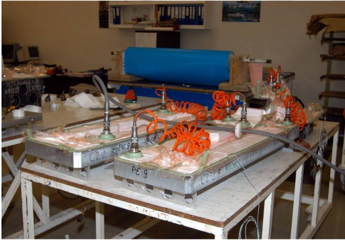
Resim 2.4. Vakum torbalama yöntemi uygulaması [16]
