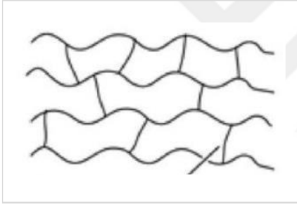
Şekil 2.5. Termosetlerin çapraz polimer bağı [14]
