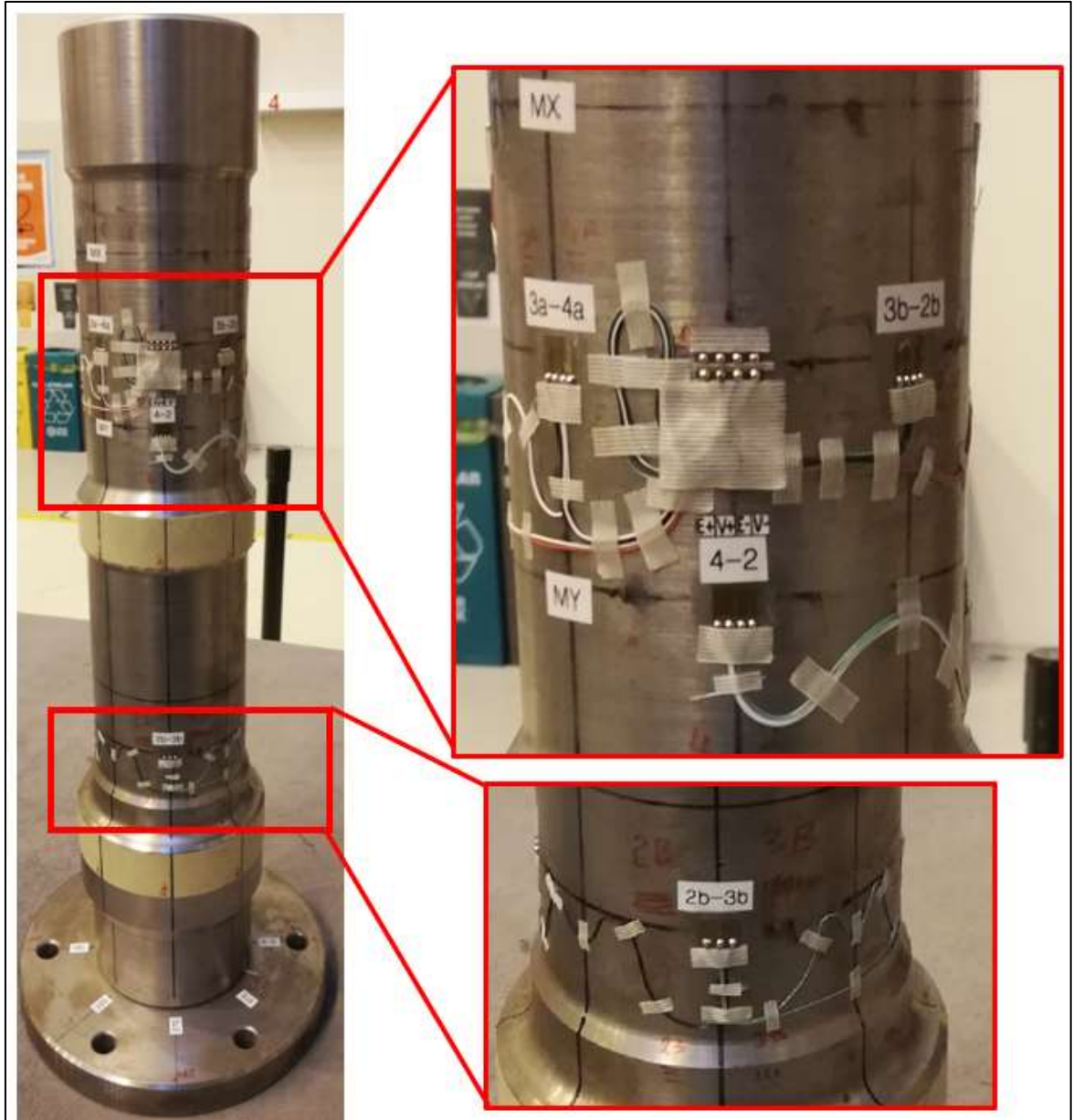
Resim 5.5. Test numunesi köprü uygulamaları-4
