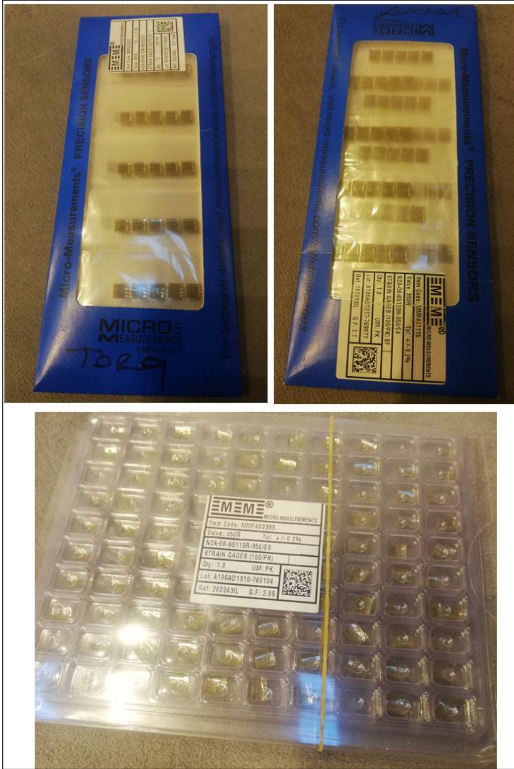
Resim 5.1. Enstrümantasyon işlemlerinde kullanılan gerinim pulları
