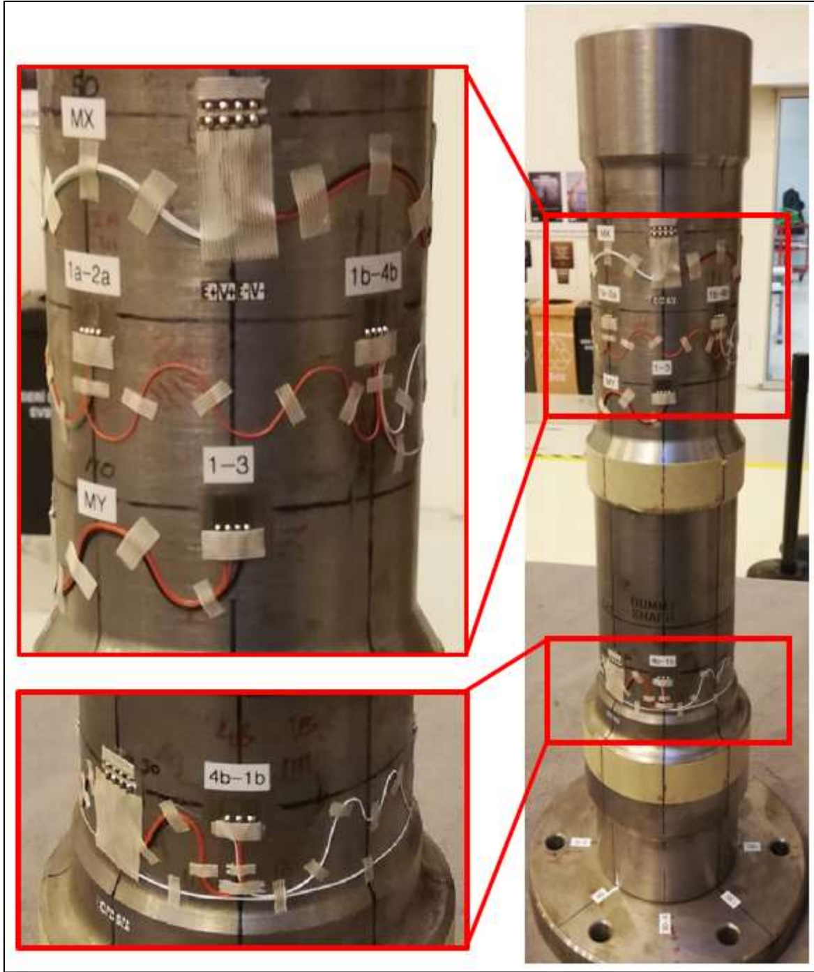
Resim 5.4. Test numunesi köprü uygulamaları-3
