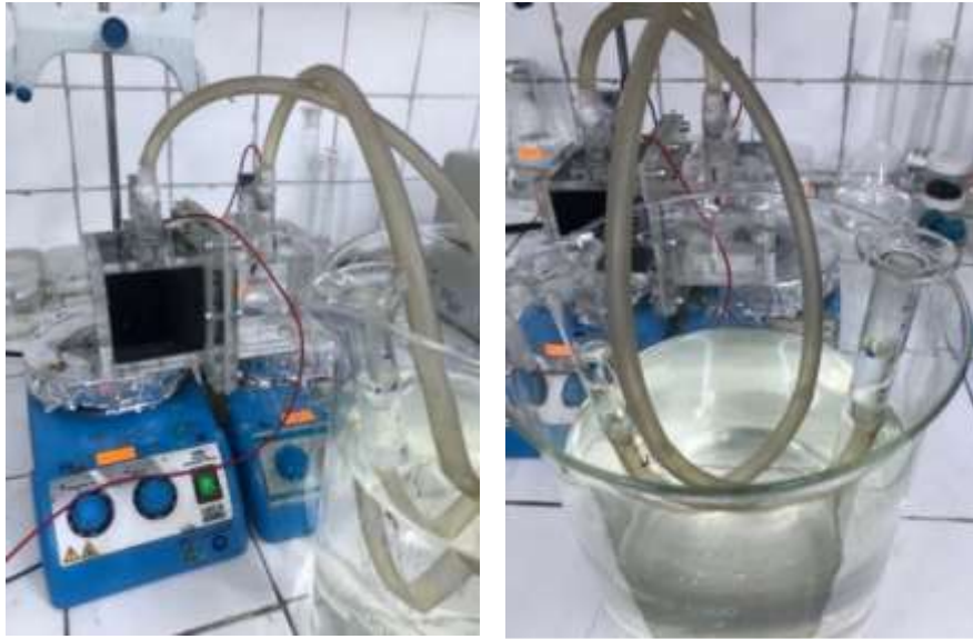
Resim 6.19. Kübik hücrede hidrojen miktarının belirlenmesi için kurulan sistem
