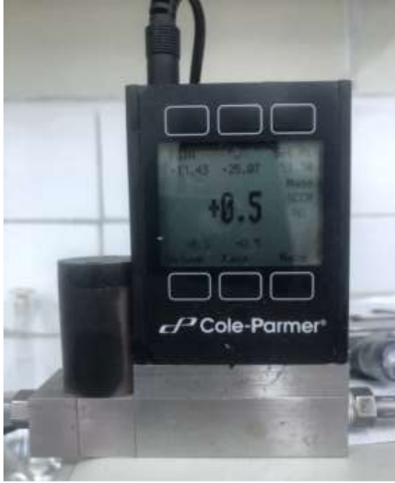
Resim 6.23. Tunçbilek linyiti elektrolizi sırasında katot bölmesine bağlanmış kütle akış ölçer ekranı
