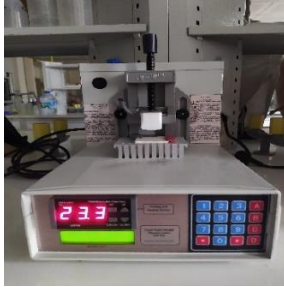
Resim 3.7. Elektriksel iletkenlik analizinde kullanılan FPP-470 Four Point Probe cihazı
