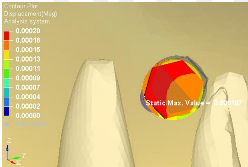
Resim 4.46. Senaryo 4'te, ortodontik kuvvet yükleme anındaki deplasmanın yakından görüntüsü
