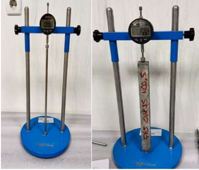
Resim 3.8. Kuruma r tresi deney aleti ve r tre deęeri  l  len numune
