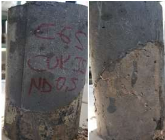
Resim 4.7. UK C oranı %35 olan eğik kesme numunelerinin basınç dayanımı görseli
