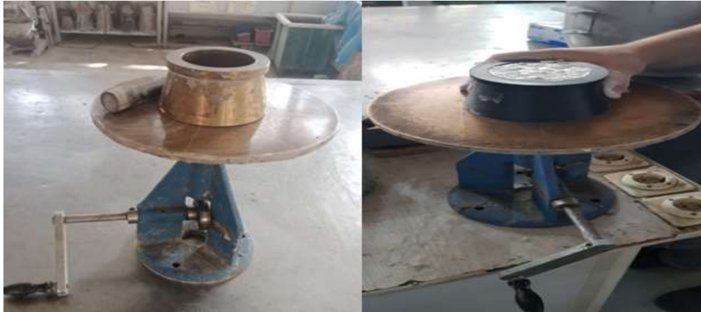
Resim 3.1. Mini yayılma test cihazı ve numune
