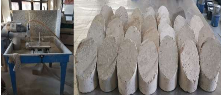
Resim 3.6. Taş kesme makinası ve 45 derece eğik kesilmiş numuneler
