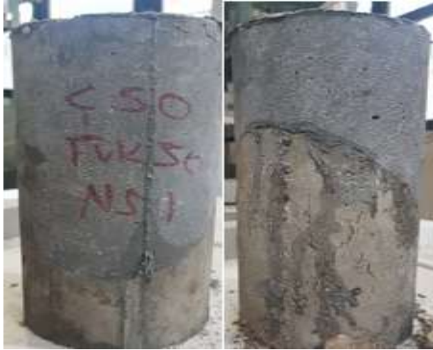
Resim 4.3. UK F oranı %50 olan eğik kesme numunelerinin basınç dayanımı görseli
