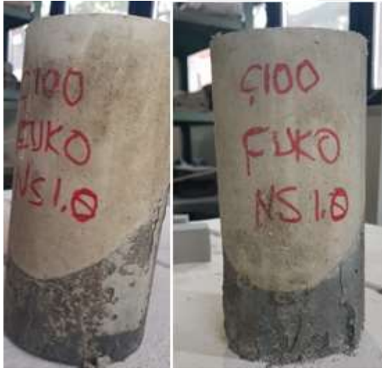
Resim 4.2. UK F oranı %0 olan eğik kesme numunelerinin basınç dayanımı görseli
