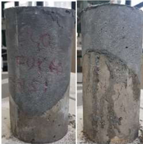
Resim 4.4. UK F oranı %60 olan eğik kesme numunelerinin basınç dayanımı görseli
