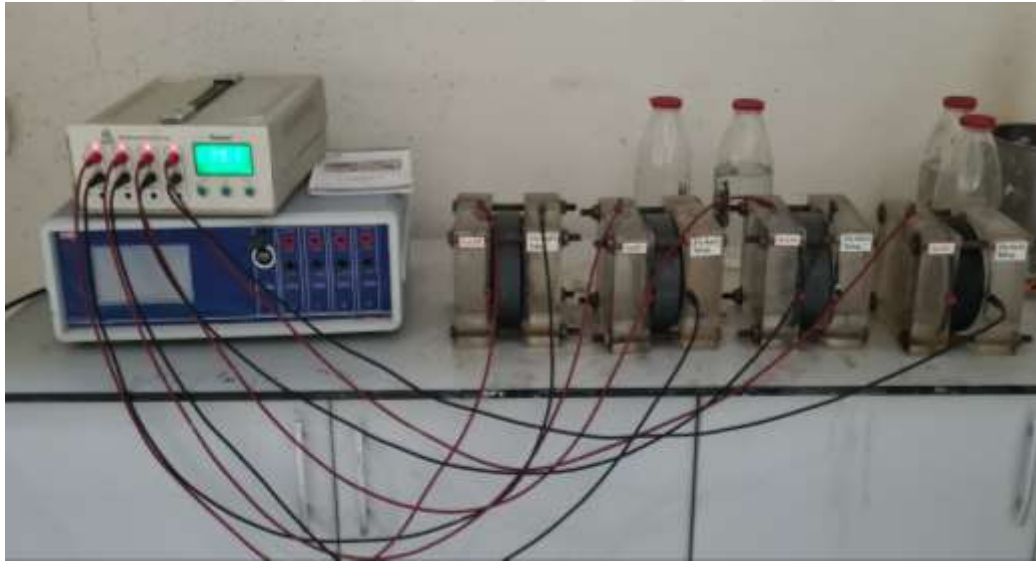
Resim 3.10. Hızlı klor iyon geçirimsizliği, elektro-mekanik test cihazı ve ekipmanları
