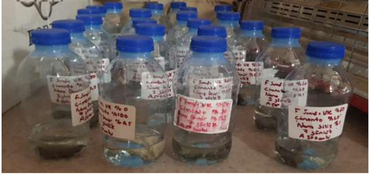
Resim 3.11. SEM analizinde kullanılmak üzere aseton içerisinde atılmış olan numuneler
