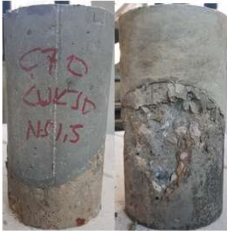
Resim 4.6. UK C oranı %30 olan eğik kesme numunelerinin basınç dayanımı görseli
