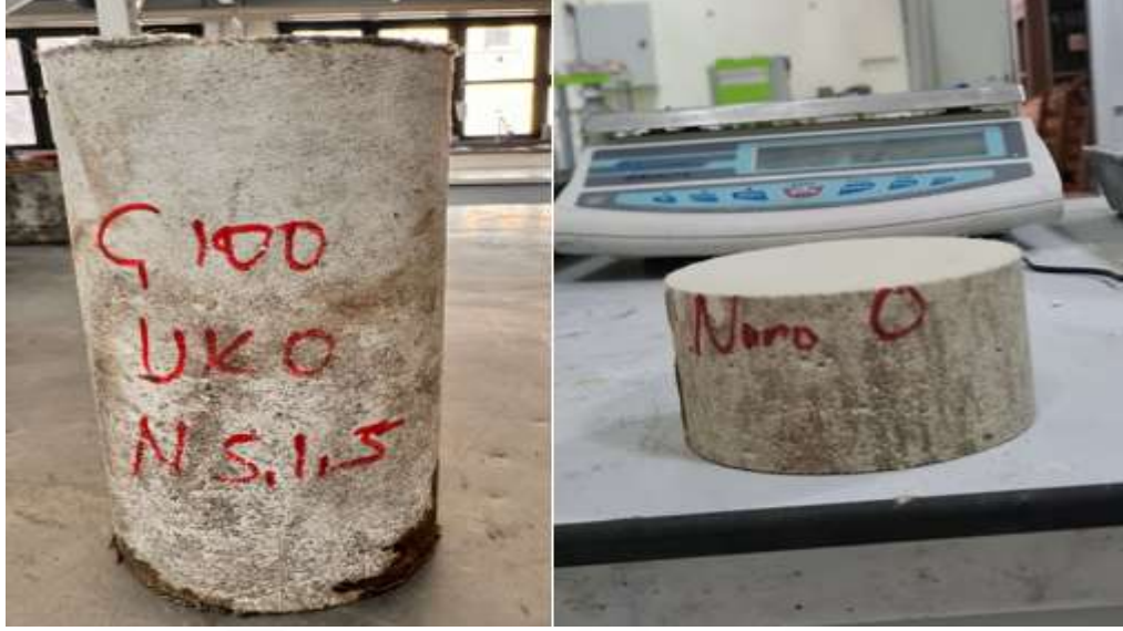
Resim 3.9. Ø100×200 mm silindir numune ve elmas bıçaklı testere ile kesilmiş Ø100×50 mm silindir disk numune
