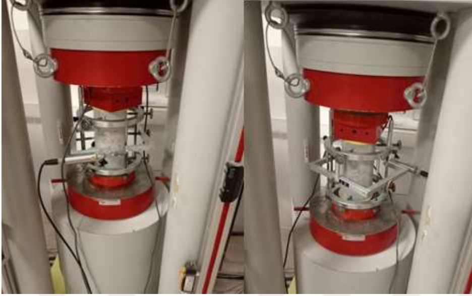
Resim 4.1. UK_F 'lü ve UK_C 'lü tasarımlara ait EM deney düzeneği
