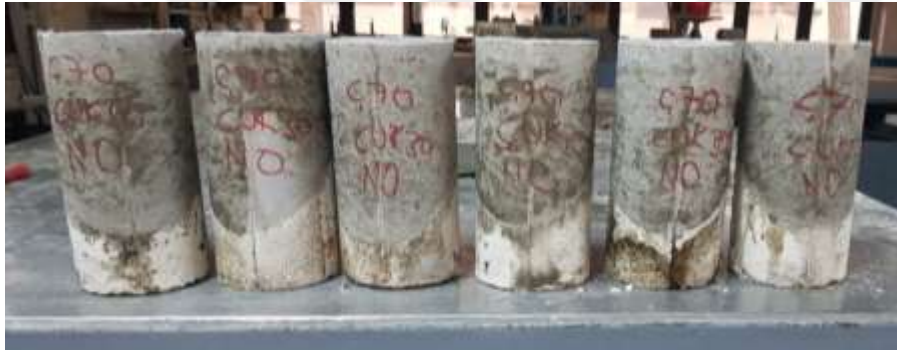
Resim 3.7. Eski 45 derece eğik kesilmiş numunelerle birlikte dökülen numuneler
