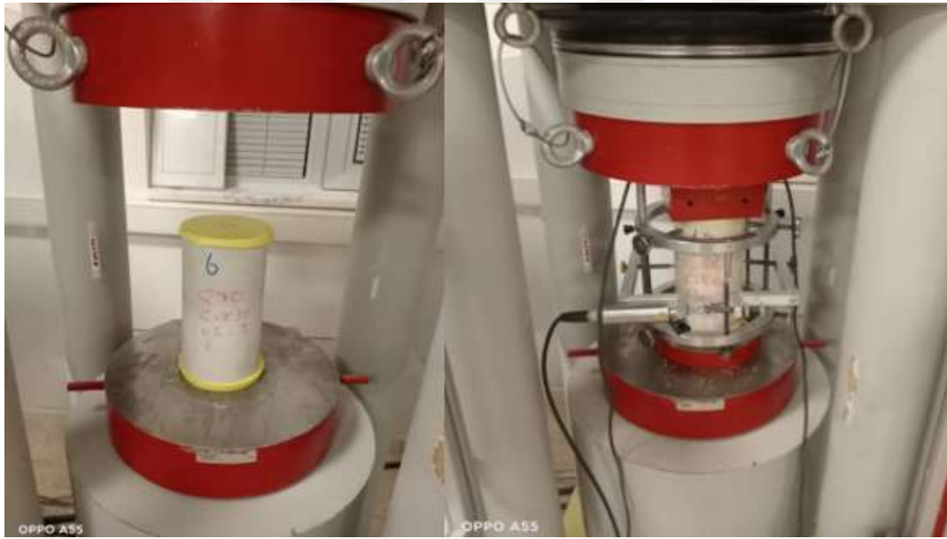
Resim 3.5. Elastisite modülü numunesi ve deney düzeneği
