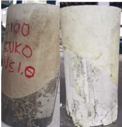
Resim 4.5. UK C oranı %0 olan eğik kesme numunelerinin basınç dayanımı görseli
