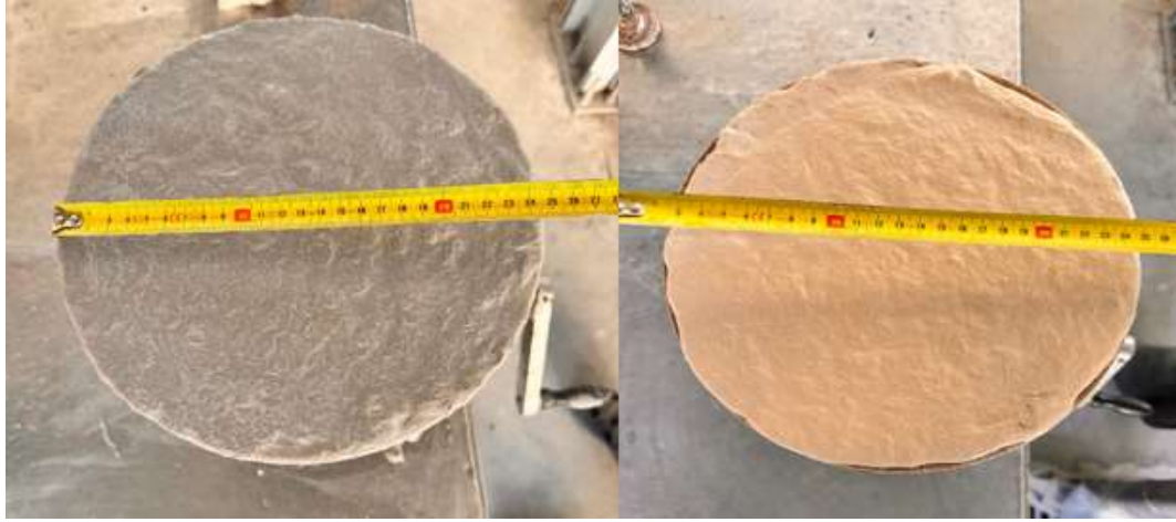
Resim 3.2. Mini yayılma testi numune ölçümleri
