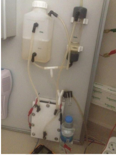
Resim 3.3. PEM(polimer elektrolitik membran) yakıt pili sistemi
