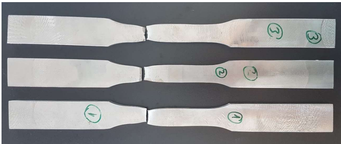
Resim 4.2. TGG numunelerin çekme deney sonucu hasar görüntüleri
