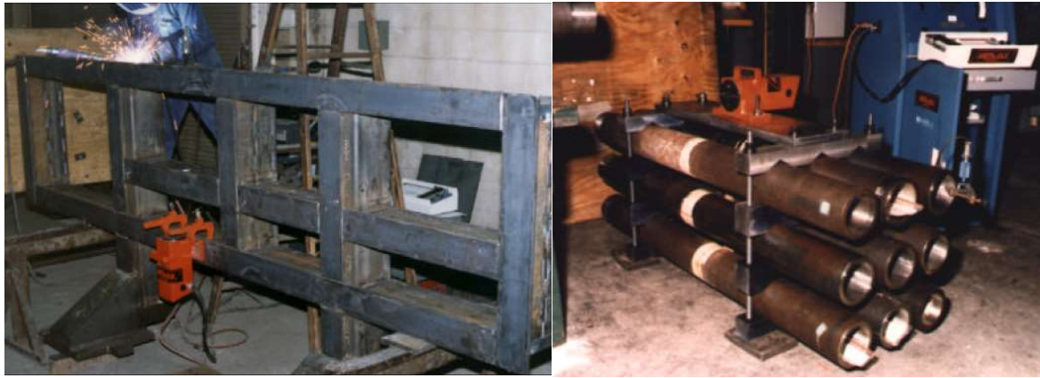
Resim 2.1. Titreşimle gerilme giderme uygulama örnekleri [25]
