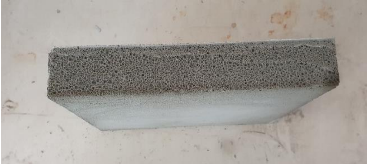
Resim 3.25. Isıl iletkenlik tayini için üretilen köpük beton numunesi
