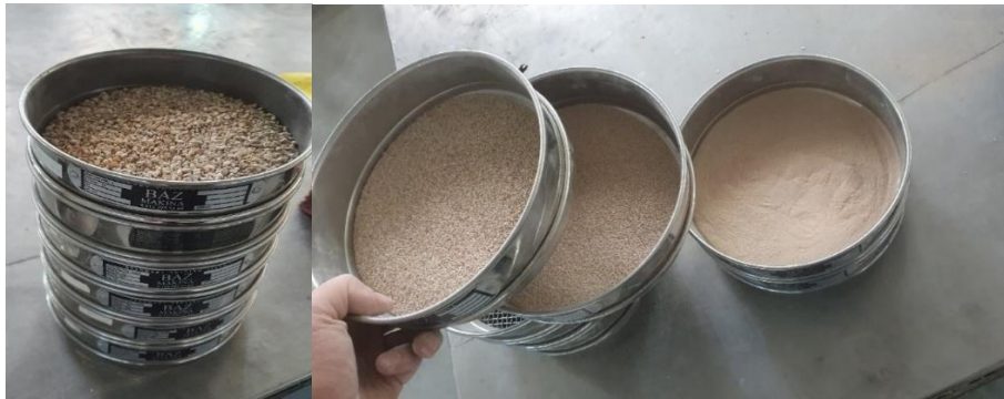
Resim 3.14. Geri dönüşüm agregası elek analizi deneyi
