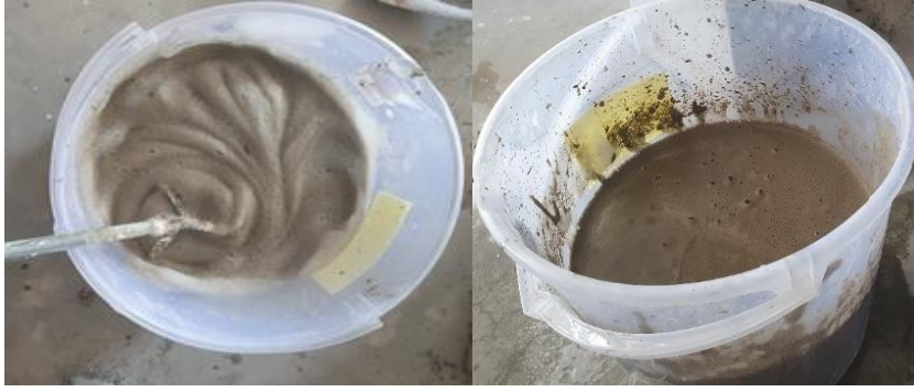
Resim 3.11. Üretilen harç ve köpüğün birleştirilerek karıştırılması
