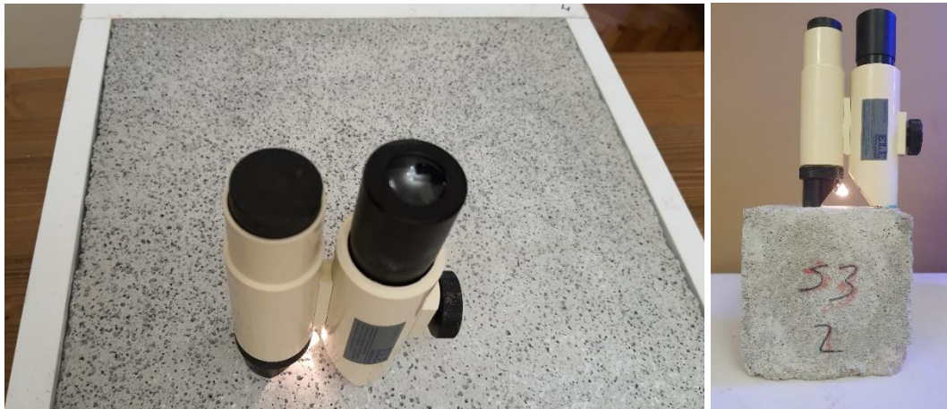
Resim 3.27. Köpük betonun boşluk yapısının ölçümü
