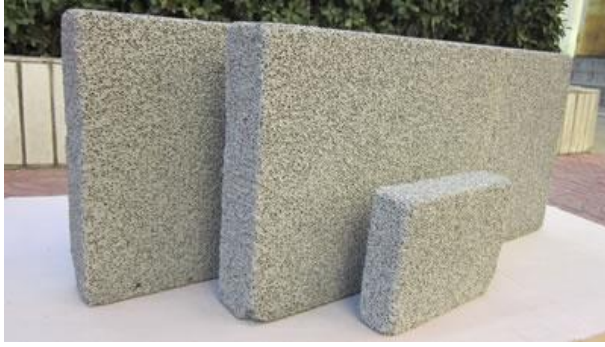
Resim 2.1. Köpük betonun görünümü [21].
