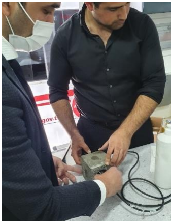
Resim 3.21. Ultrases geçiş hızı ölçüm işlemi
