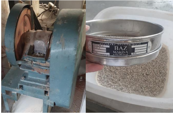
Resim 3.1. Deneylerde kullanılan konkasör ve geri dönüşüm agregasının elenmesi
