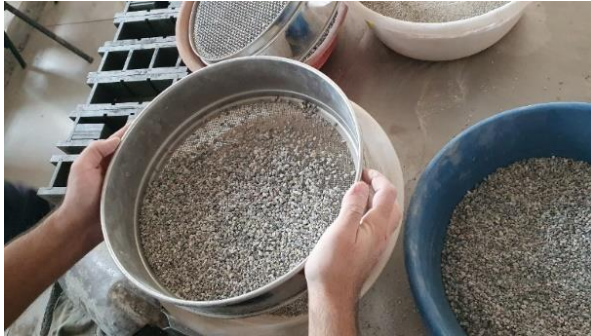
Resim 3.8. Geri dönüşüm agregasının elenmesi
