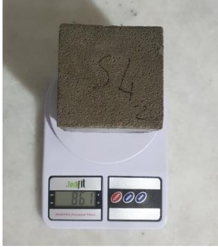
Resim 3.19. Suya doęun halde olan kpk beton numunelerinin lm
