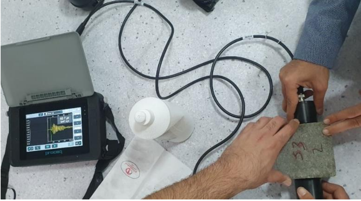
Resim 3.22. Ultrases geçiş hızının okunması
