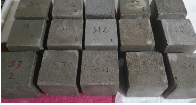
Resim 3.18. Suya doęun hale getirilmiř kpk beton numuneleri
