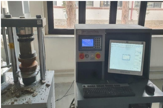
Resim 3.17. Köpük beton numunelerinin kırımı
