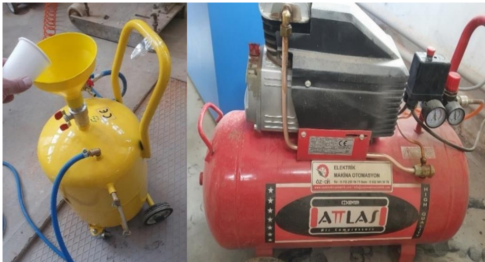
Resim 3.4. Köpük püskürtme pompası ve hava kompresörü
