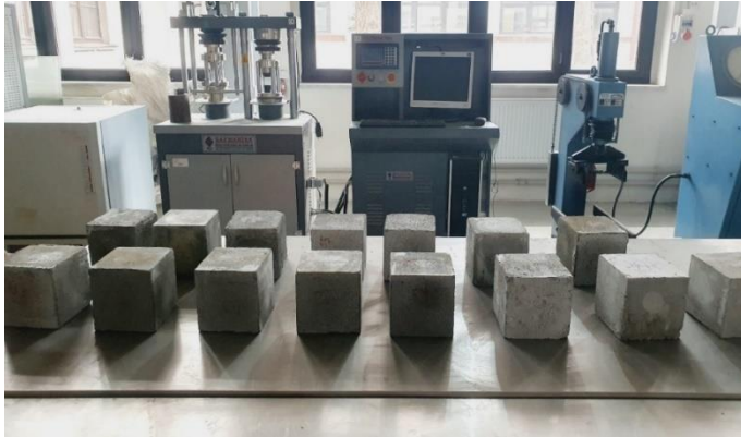
Resim 3.16. Kırılmak üzere hazırlanmış köpük beton numuneleri
