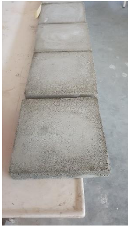
Resim 3.24. 30x30x5cm boyutlarında üretilen köpük beton plakaları
