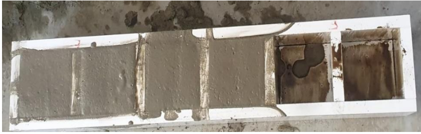
Resim 3.12. Üretilen köpük betonun yağlanmış kalıplara dökümü
