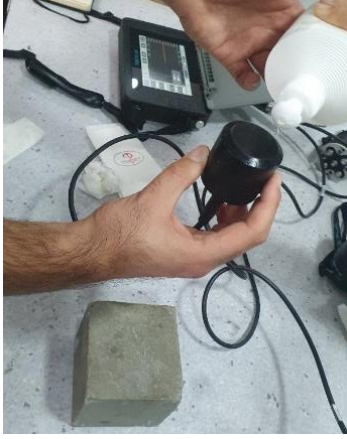
Resim 3.20. PL Pundit 200 cihazı ve problemin yağlanması işlemi
