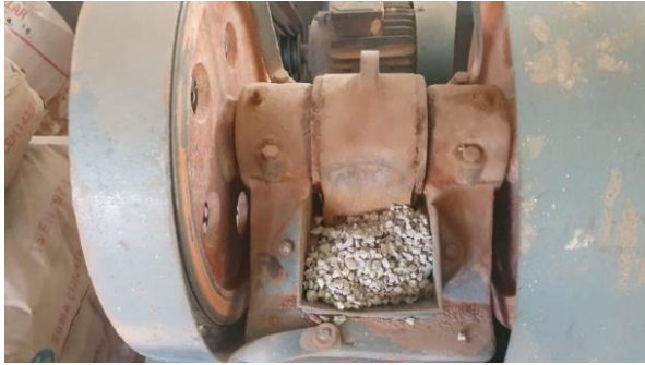
Resim 3.7. Geri dönüşüm agregasının kırılması
