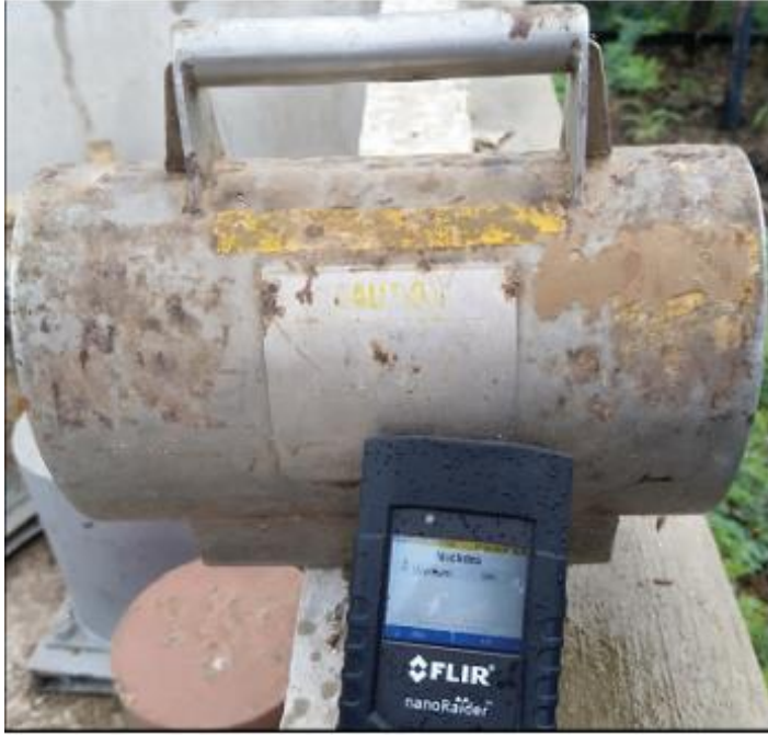
Resim 2.2. UAEA denetimi esnasında etiket üzerindeki bilgiler mevcut veya görünür olmadığında DU zırhın gama spektrometresi ile tanımlanmasına örnek [1]
