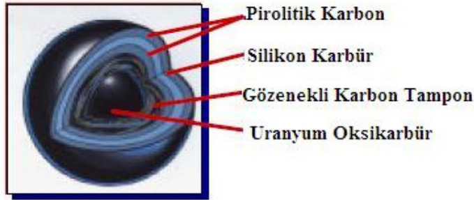
Şekil 2.10. TRISO tipi yakıtın bölümleri [33]
