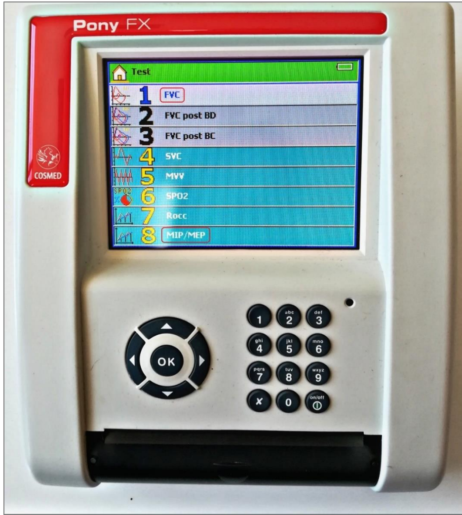
Resim 3.4. Cosmed pony FX (Roma, İtalya) taşınabilir spirometre ve solunum basınç ölçüm cihazı
