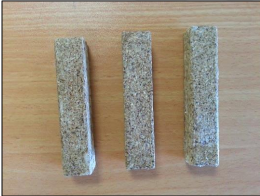
Resim 4.2. 1,7×1,7×9,8 cm’lik çubuk bloklar
