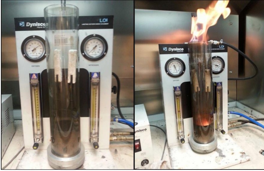
Resim 4.4. Test öncesi ve test anındaki LOİ düzeneği
