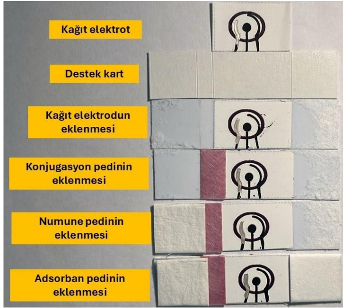
Şekil 4.30. Kağıt elektrot, numune pedi, konjugasyon pedi ve adsorban pedinin bir araya getirilmesiyle oluşturulan 15 mm genişliğindeki elektrokimyasal yatay akış test stripti
