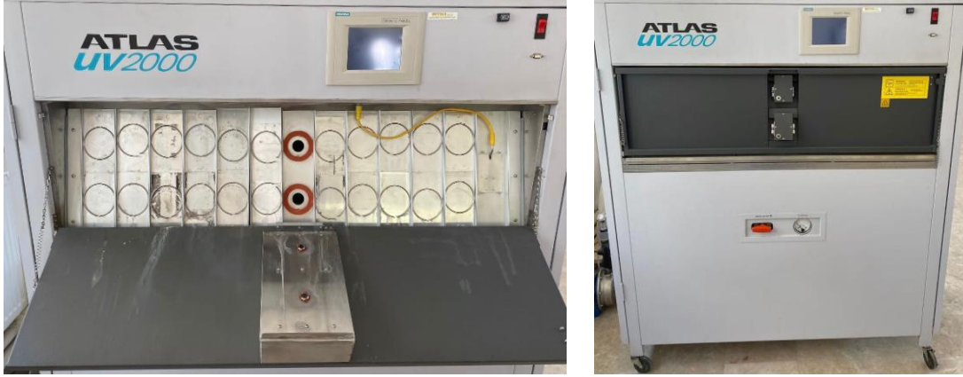
Resim 3.3. Çalışmada kullanılan yaşlandırma cihazı
