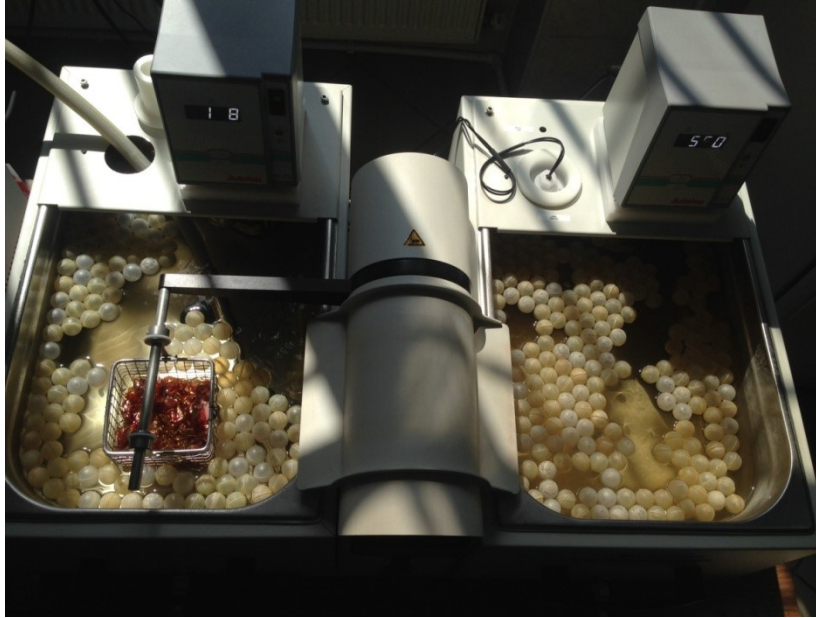
Resim 3.10. Örneklere ısısal döngü uygulaması
