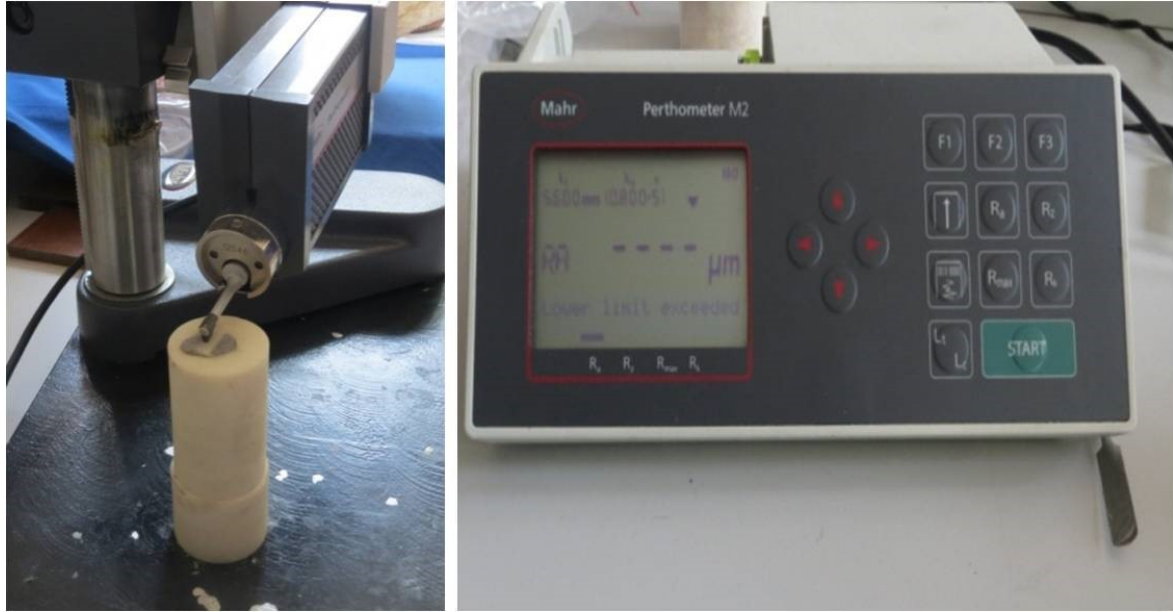
Resim 3.13. Örnek yüzeylerinin profilometre ile ölçülmesi
