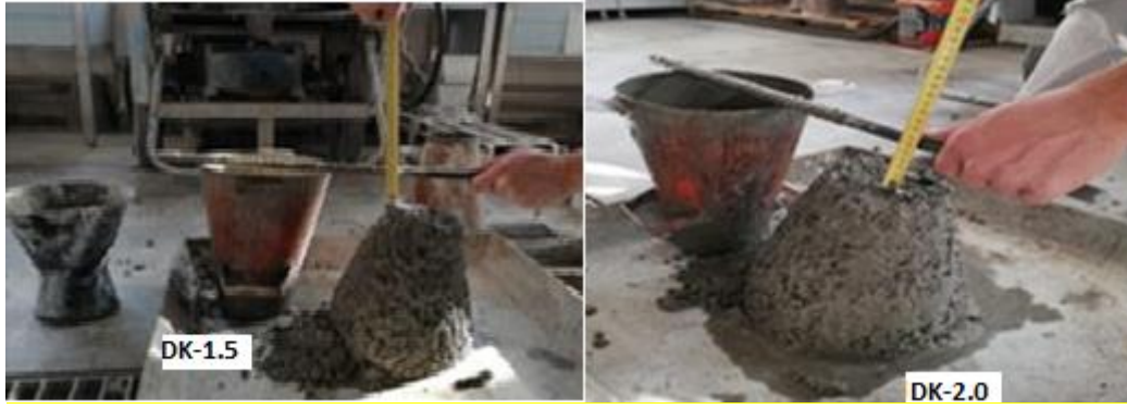
Resim 3.3. Doğal kumla üretilen taze beton çökme(slump) deneyi
