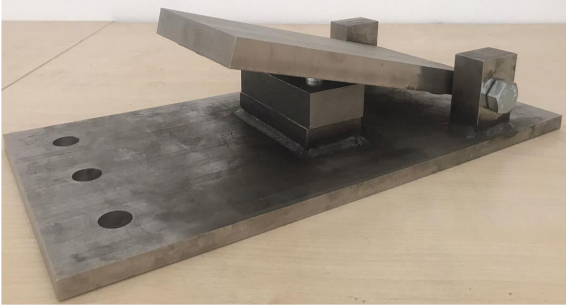
Resim 4.12. Üretilmiş olan açısız deformasyon test düzeneği
