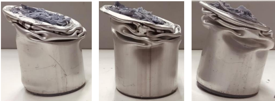
Resim 4.20. 3M151, 3M152 ve 3M153 modellerinin deformasyon görüntüsü
