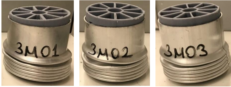
Resim 4.16. 3M01, 3M02 ve 3M03 modellerinin deformasyon görüntüsü
