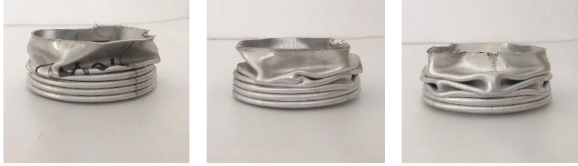
Resim 4.13. 0M01, 0M02 ve 0M03 modellerinin deformasyon görüntüsü
