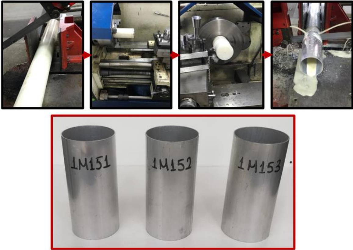
Resim 4.9. Alüminyum için işlem sırası
