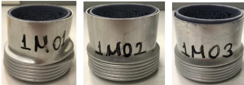
Resim 4.14. 1M01, 1M02 ve 1M03 modellerinin deformasyon görüntüsü
