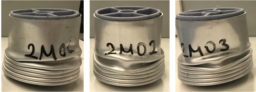
Resim 4.15. 2M01, 2M02 ve 2M03 modellerinin deformasyon görüntüsü
