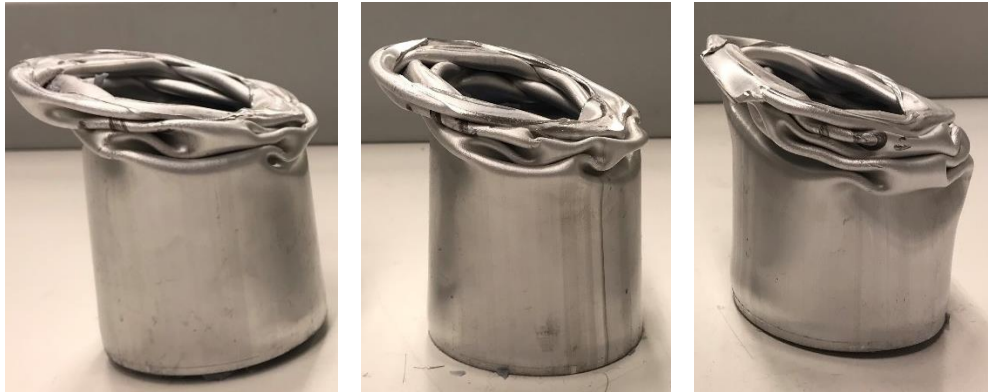
Resim 4.18. 1M151, 1M152 ve 1M153 modellerinin deformasyon görüntüsü
