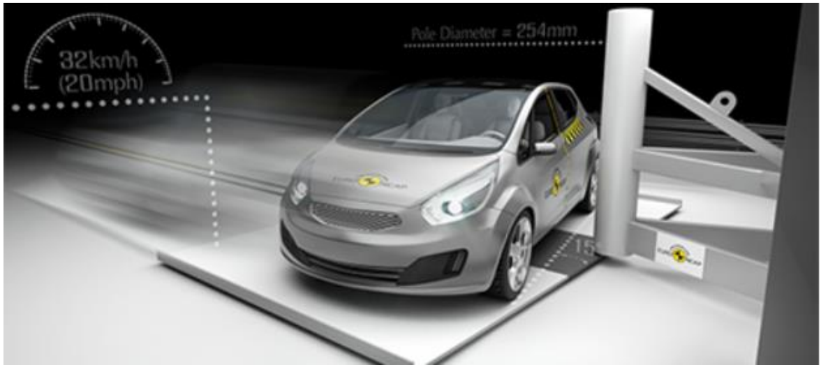
Resim 2.3. Direk arpma testi [8]
