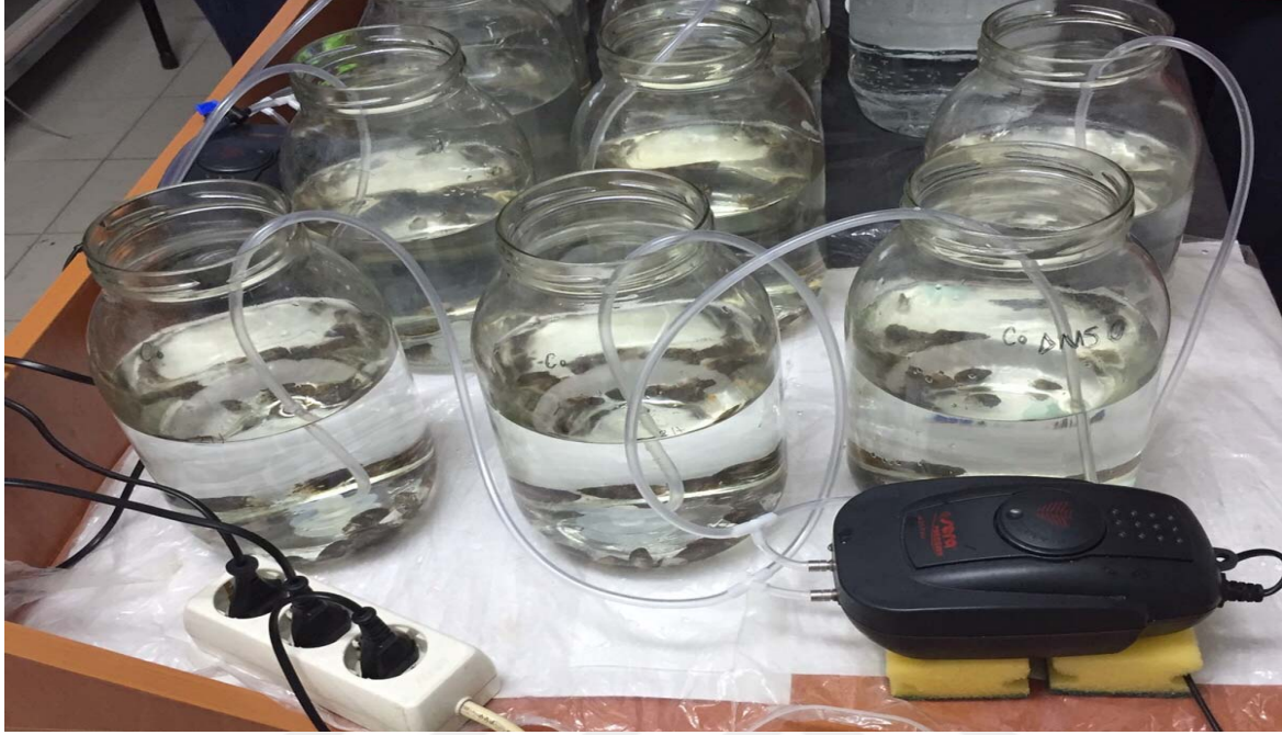
Resim 3.2. Zebra midye ( D. polymorpha ) biyodeney düzeneği
