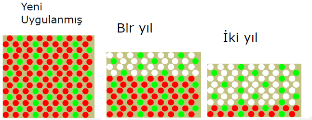
Resim 2.5. Standard bir antifouling boyanın çalışma mekanizması (Özan, 2014)
