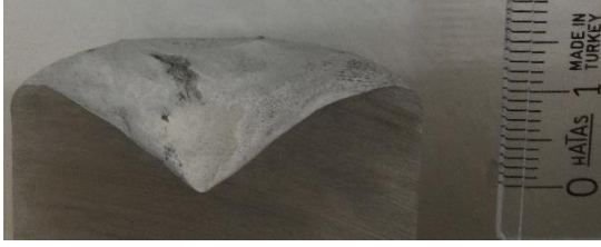
Resim 4.5. Kokil kalıp ile üretilen numunenin çekme boşluğu
