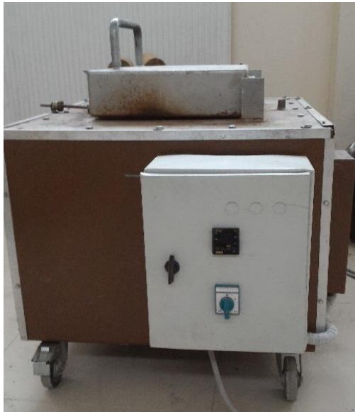
Resim 3.1. Elektrik rezistanslı ertitme ocağı
