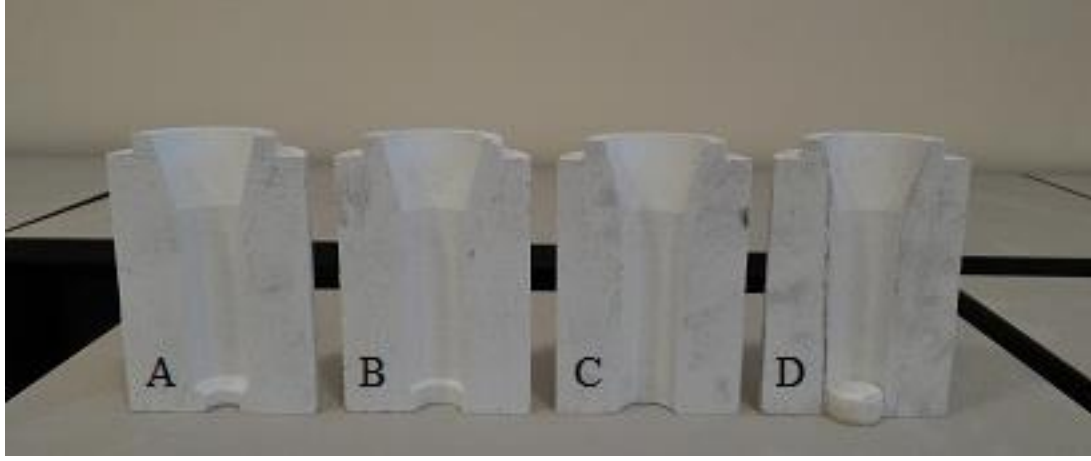
Resim 3.4. Dört farklı soğuma hızının elde edilmesi için hazırlanan tasarımlar
