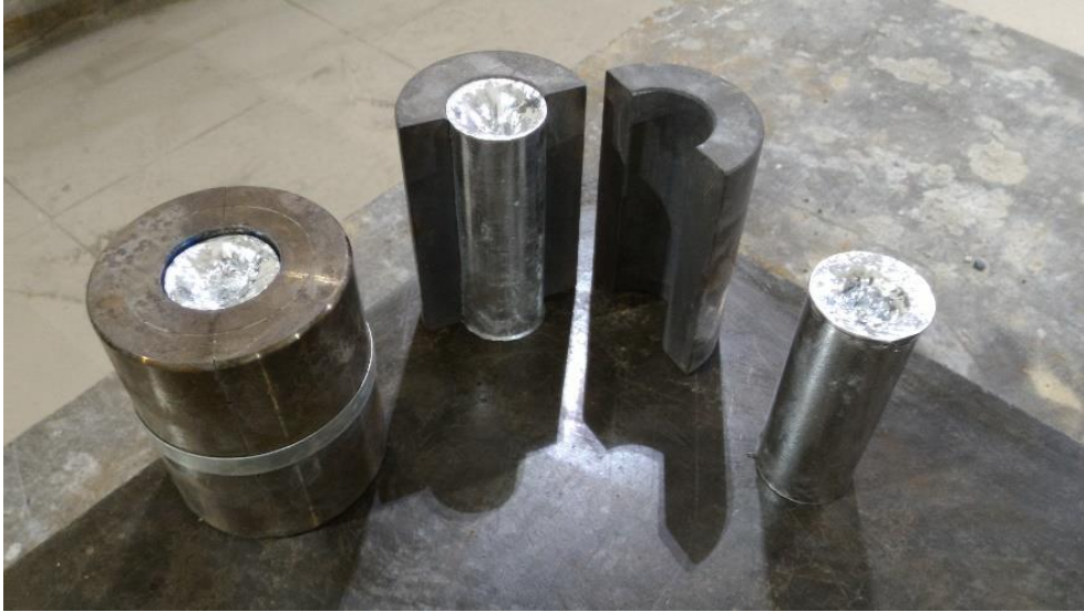
Resim 3.2. Ön-numune üretiminde kullanılan kokil kalıplar ve üretilen ön-numune
