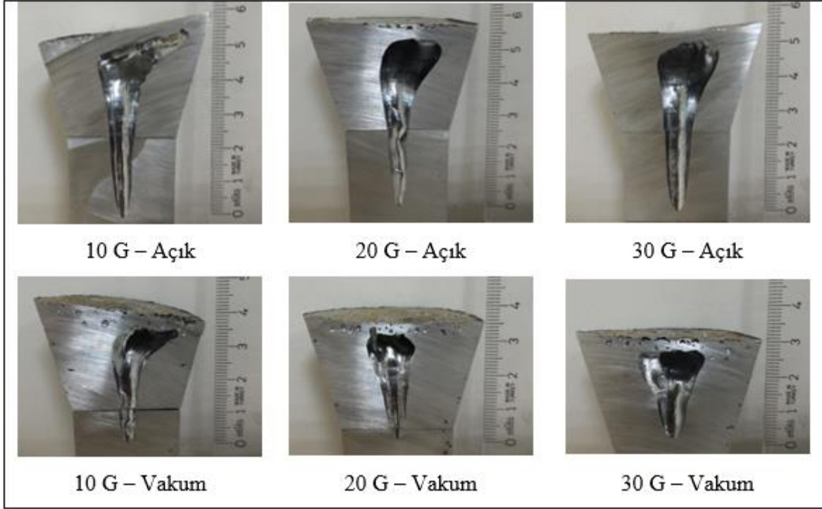
Resim 4.4. D kalıbı ile üretilen numunelerdeki çekme boşlukları
