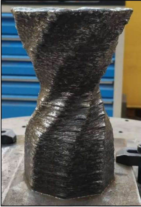
Resim 6.15. Üretilen parçanın tepe bölgesinde gözlemlenen dalgalı yüzey formunun görünüşü
