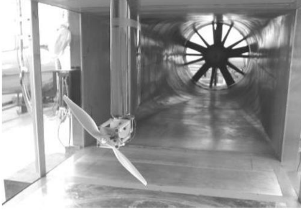
Resim 3.2. Pervane testleri için kullanılan rüzgar tüneli [43]
