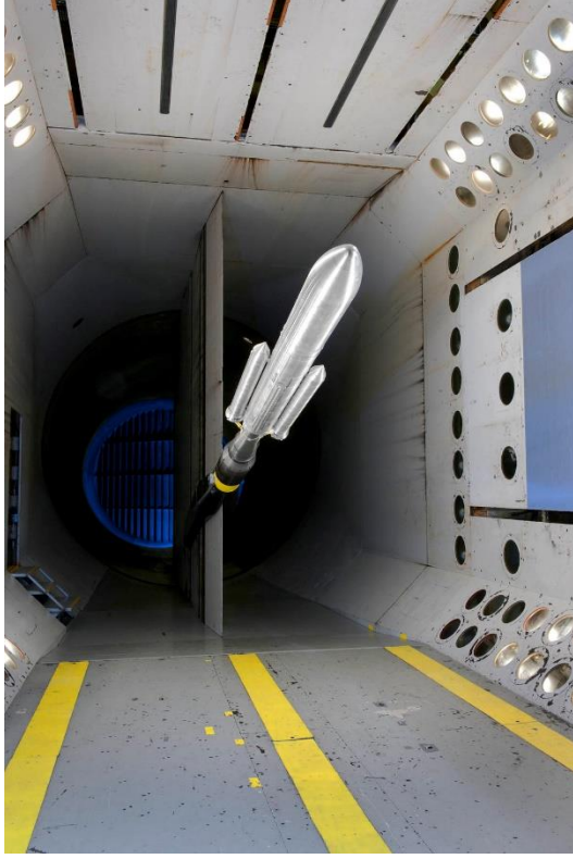
Resim 2.10. Roket transonik rüzgar tüneli testi [23]
