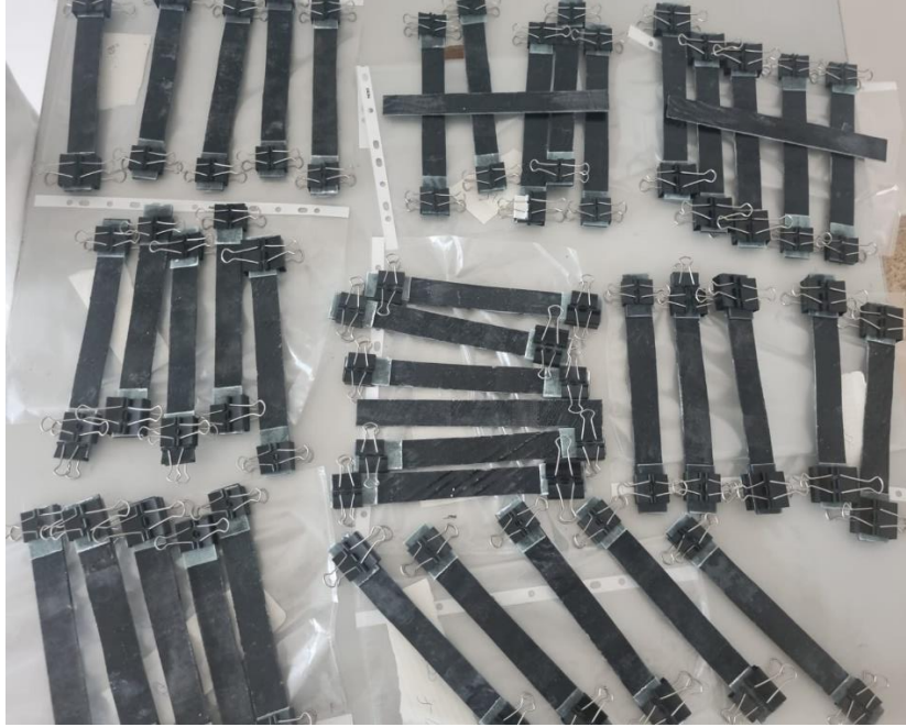
Şekil 4.7. Çekme numunelerinin sıkıştırma plakası ile yapıştırılması
