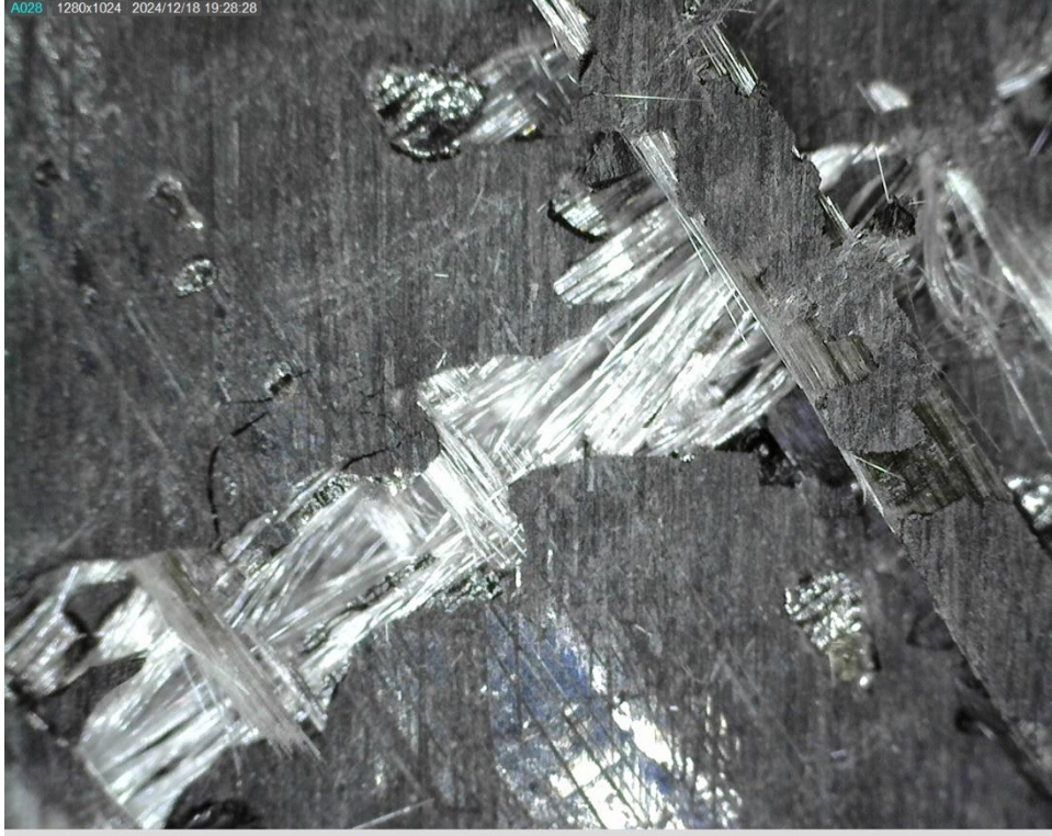
Şekil 5.78. Çekme numunesinde oluşan hasar modunun mikroskop altında yakınlaştırılmış kalınlık görüntüsü
