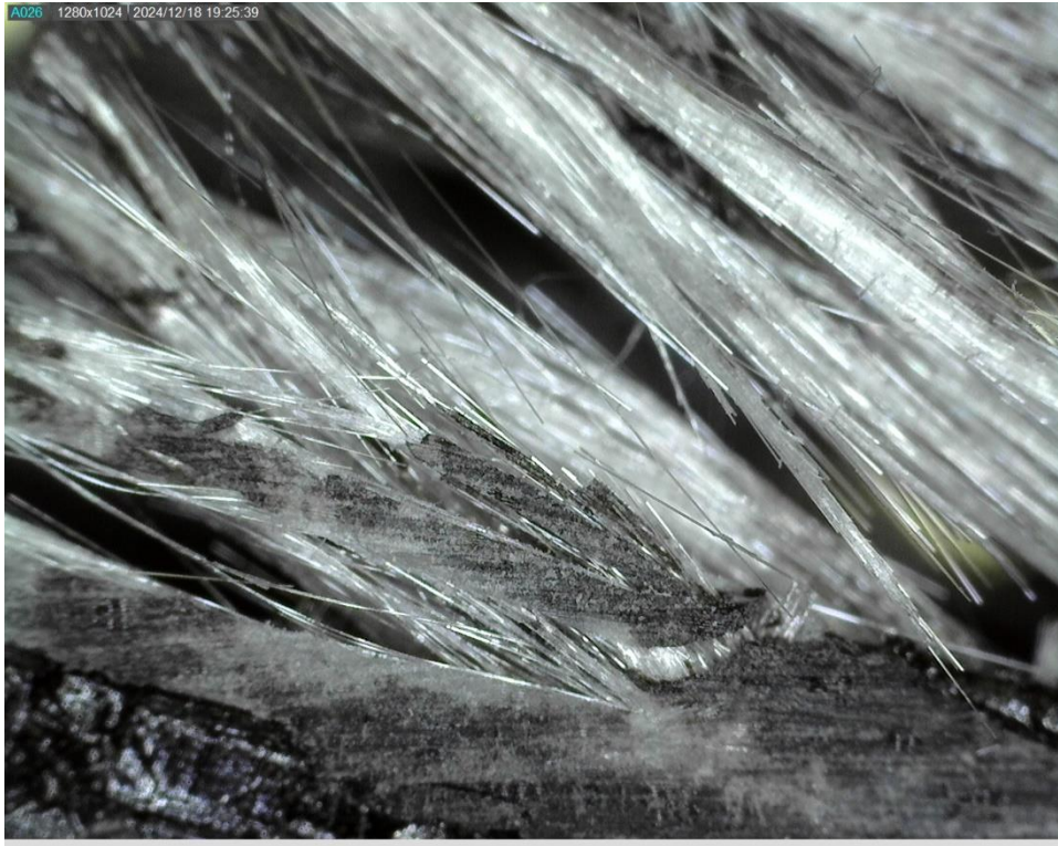
Şekil 5.77. Çekme numunesinde oluşan hasar modunun mikroskop altında yakınlaştırılmış kalınlık görüntüsü
