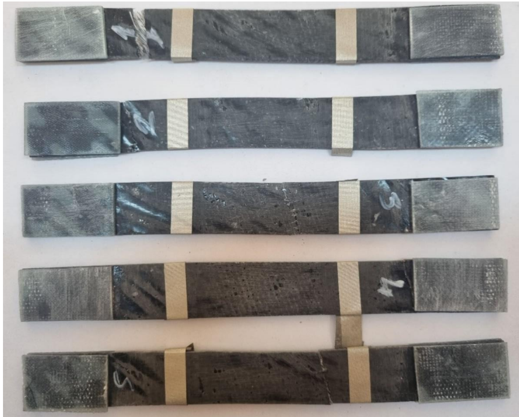
Şekil 5.67. 75° yönelimli GFRPC numunenin çekme deneyinde kopma davranışı
