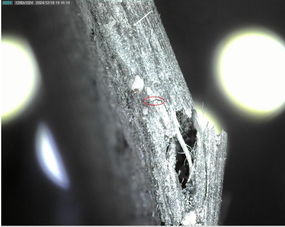
Şekil 5.36. Eğme numunesinde oluşan hasar modunun mikroskop altında yakınlştırılmış kalınlık görüntüsü
