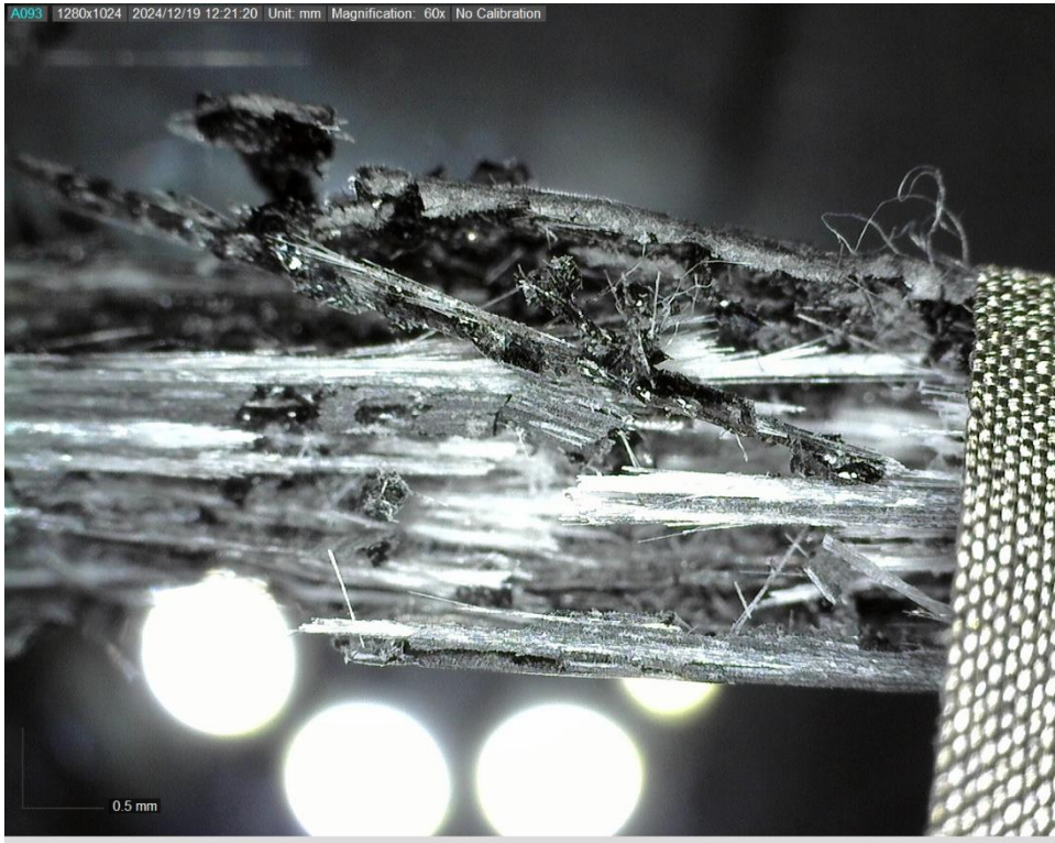
Şekil 5.71. 0° yönelimli GFRPC numunenin mikroskop altında yakınlştırılmış kalınlık görüntüsü
