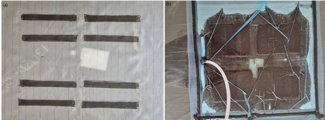
Şekil 4.3. a) Cam fiber serimi yapılmadan önce, b) Cam fiber serim işlemi tamamlandıktan sonra
