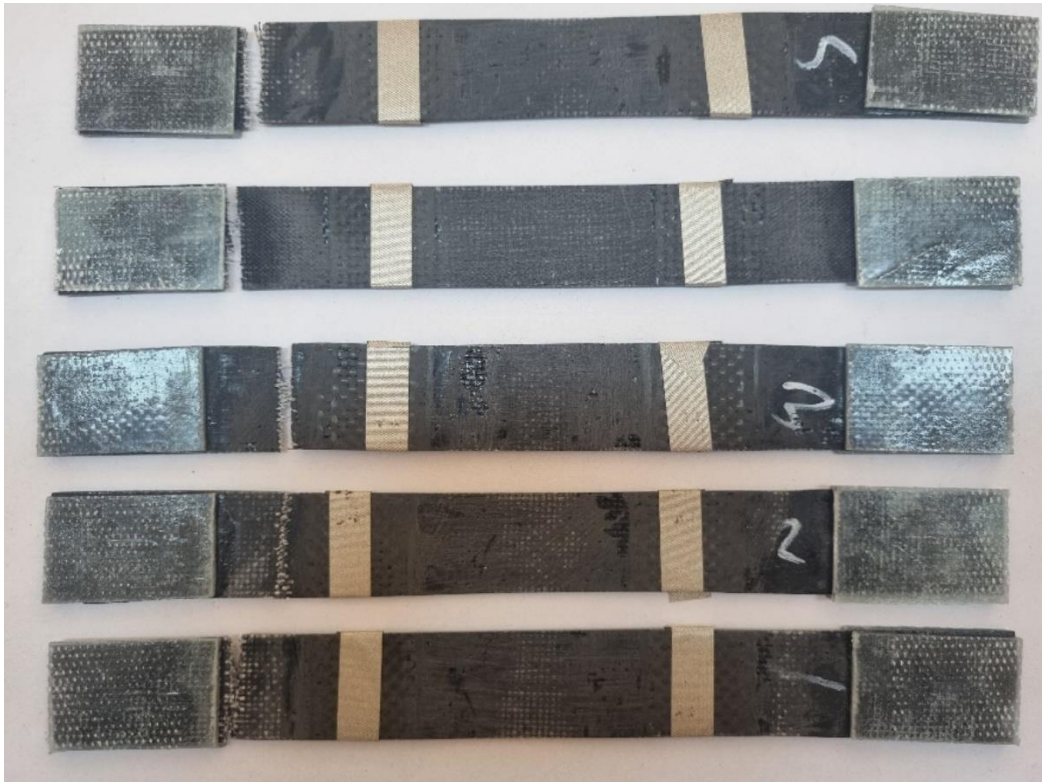
Şekil 5.69. 200gr/m 2 alansal yoğunluklu dokuma GFRPC numunenin çekme deneyinde kopma davranışı
