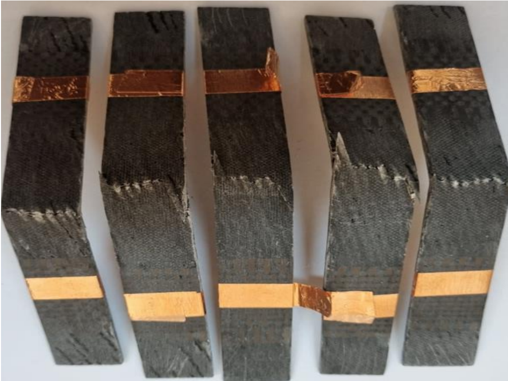
Şekil 5.21. 15° yönelimli GFRPC numunenin kırılma tipi
