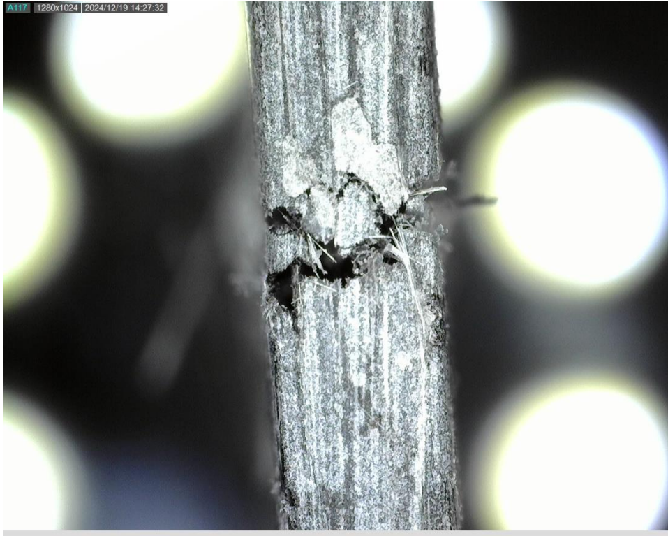
Şekil 5.75. 90° yönelimli GFRPC numunenin mikroskop altında yakınlştırılmış kalınlık görüntüsü
