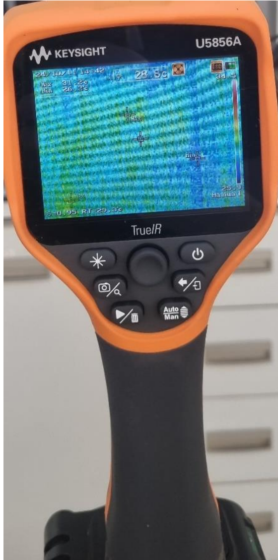
Şekil 4.11. Çekme testi boyunca kullanılan termal kamera
