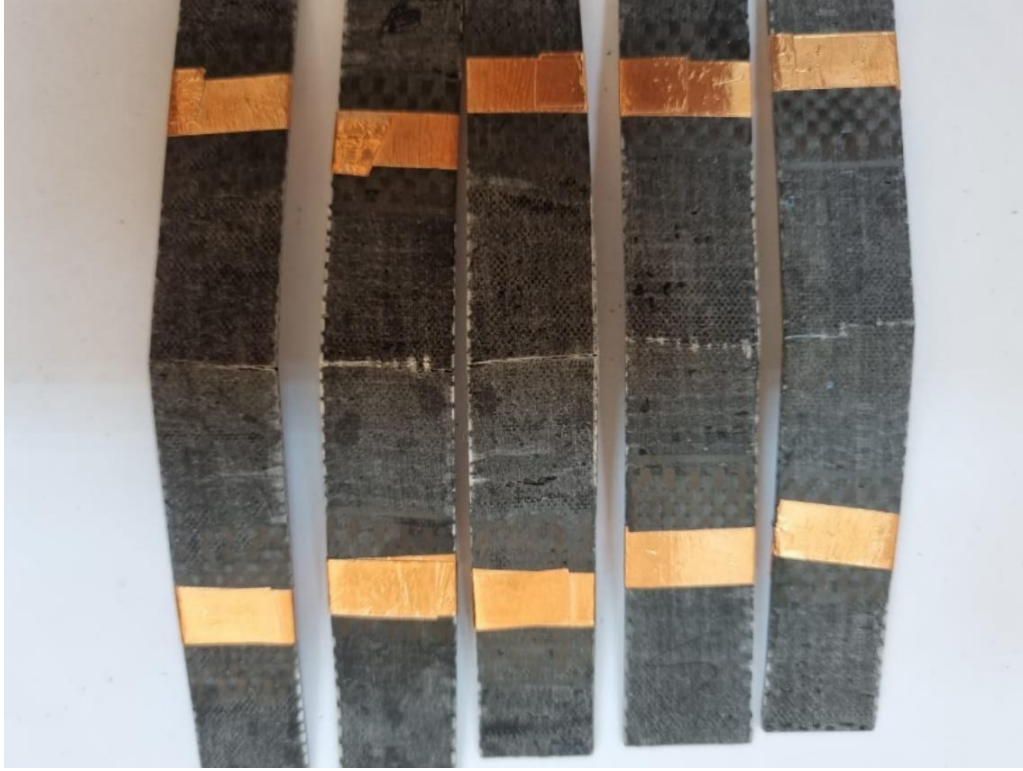
Şekil 5.26. 90° yönelimli GFRPC numunenin kırılma tipi
