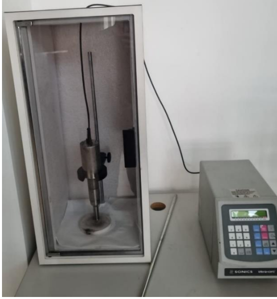
Şekil 4.5. Çekme testi numuneleri için ultrasonik dispersiyon işleminin yapıldığı cihaz
