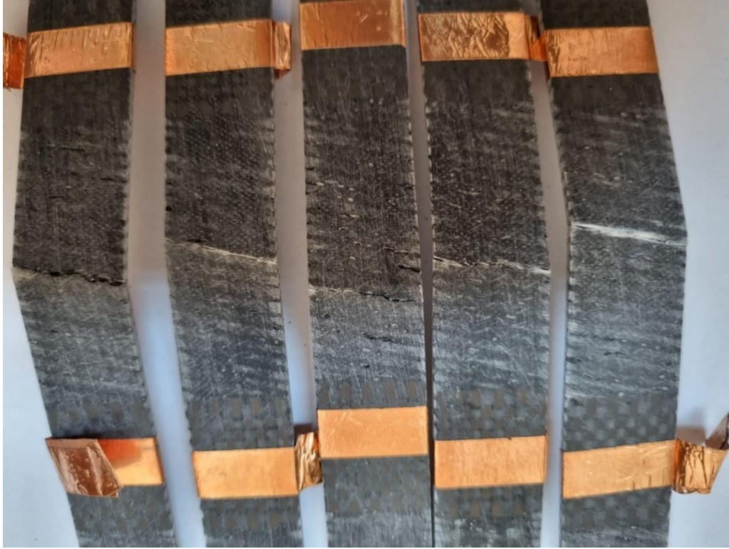
Şekil 5.25. 75° yönelimli GFRPC numunenin kırılma tipi
