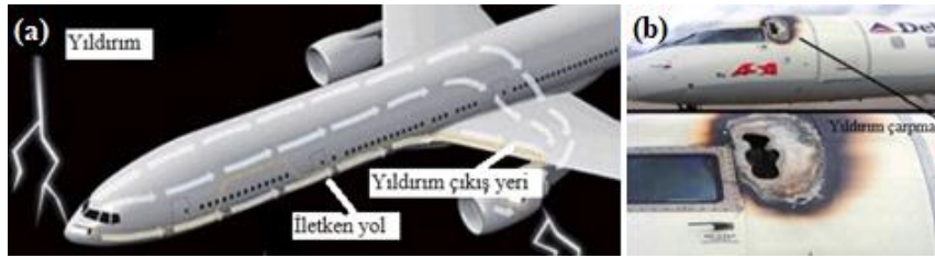
Şekil 3.10. a) Uçağın dış yapısında yıldırımını iletecek düşük dirençli yol, b) Yıldırım çarpmasının etkisi [9]
