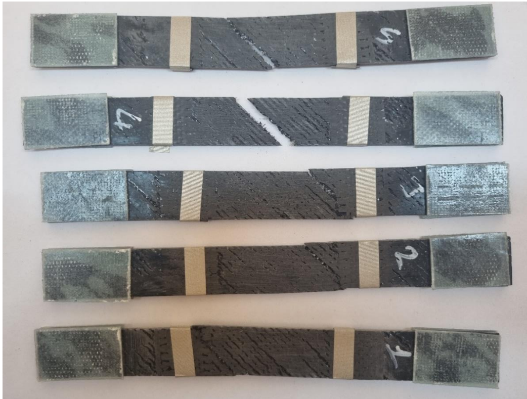
Şekil 5.65. 45° yönelimli GFRPC numunenin çekme deneyinde kopma davranışı
