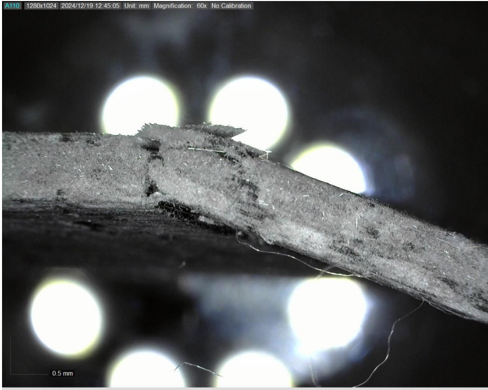
Şekil 5.31. 45° yönelimli GFRPC numunenin mikroskop altında yakınlştırılmış kalınlık görüntüsü
