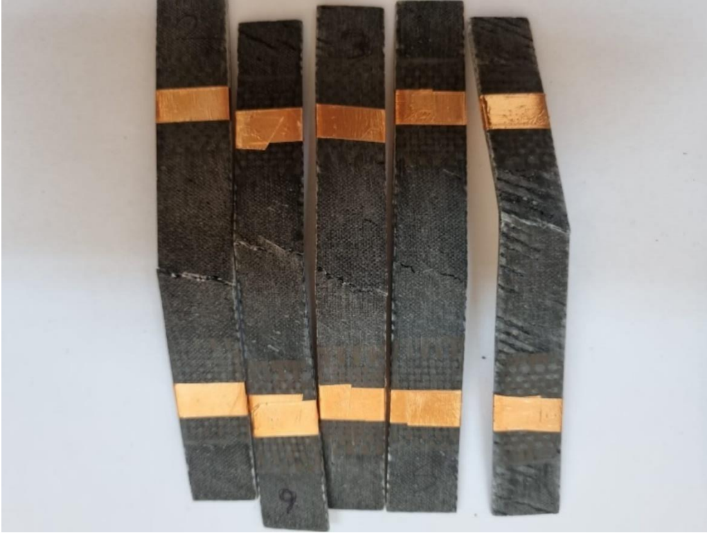
Şekil 5.22. 30° yönelimli GFRPC numunenin kırılma tipi
