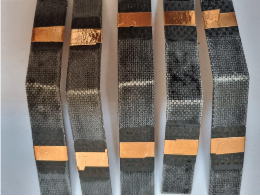
Şekil 5.28. 300gr/m 2 alansal yoğunluklu dokuma tipi kumaşla üretilmiş GFRPC numunenin kırılma tipi
