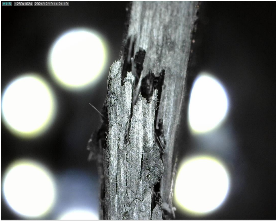
Şekil 5.73. 45° yönelimli GFRPC numunenin mikroskop altında yakınlştırılmış kalınlık görüntüsü
