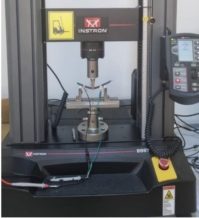
Şekil 4.9. Eğme testlerinin yapıldığı mekanik test cihazı
