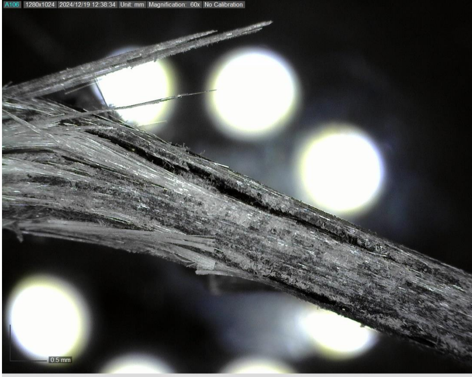
Şekil 5.29. 0° yönelimli GFRPC numunenin mikroskop altında yakınlştırılmış kalınlık görüntüsü
