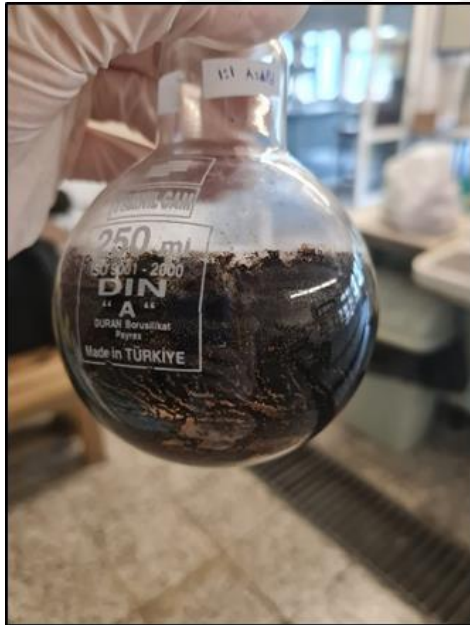
Resim 5.6. İndirgenmiş basınç altında buharlaştıktan sonra elde edilen 1:1 oranında Pd numunesi.
