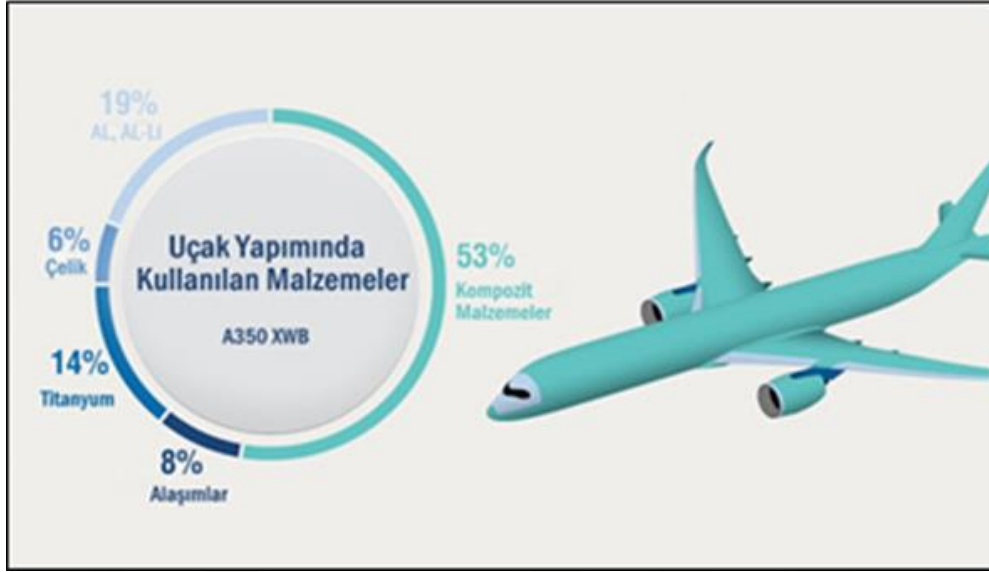
Şekil 2.3. Uçağın malzeme karışımı [24].
