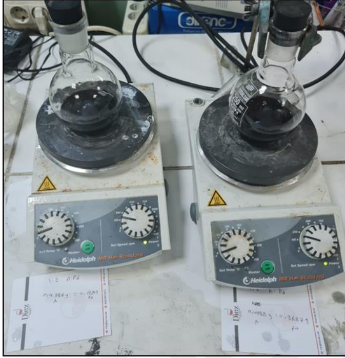
Resim 5.5. Pd bazlı katalizörleri elde etmek üzere karışımlar manyetik karıştırıcıda.
