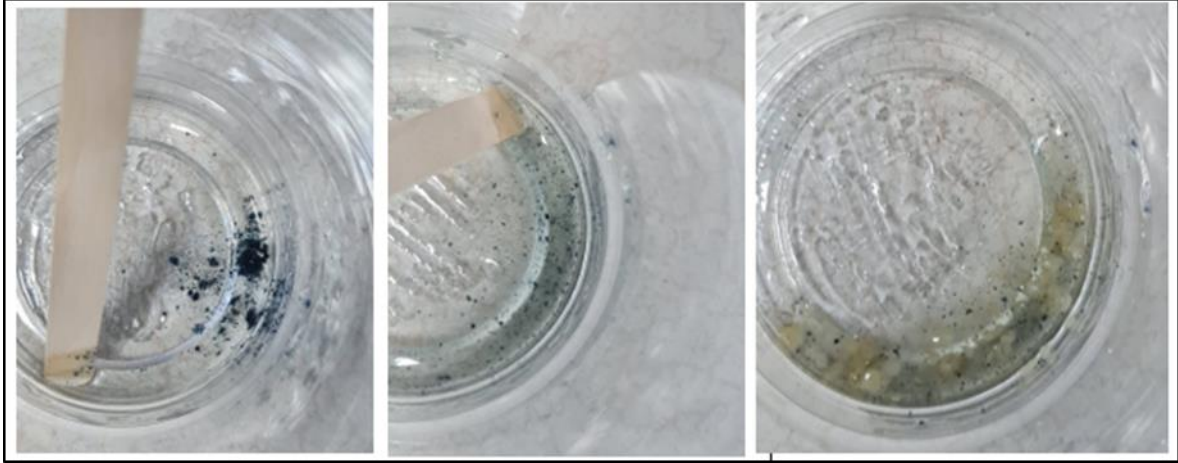
Resim 5.10. Soldan katalizörün reçineye eklenip karıştırılması ve homojen karışıma mikrokapsül eklenmesi.
