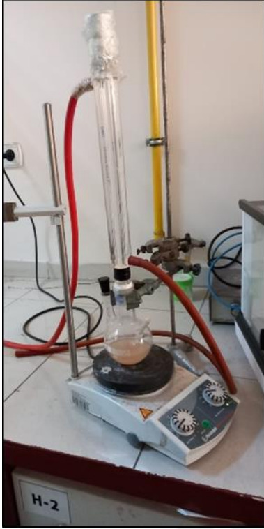
Resim 5.2. Karışım geri soğutucu'da oda sıcaklığında.
