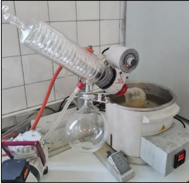
Resim 5.4. Vakumda buharlaştırma yapan döner buharlaştırıcı cihazı.
