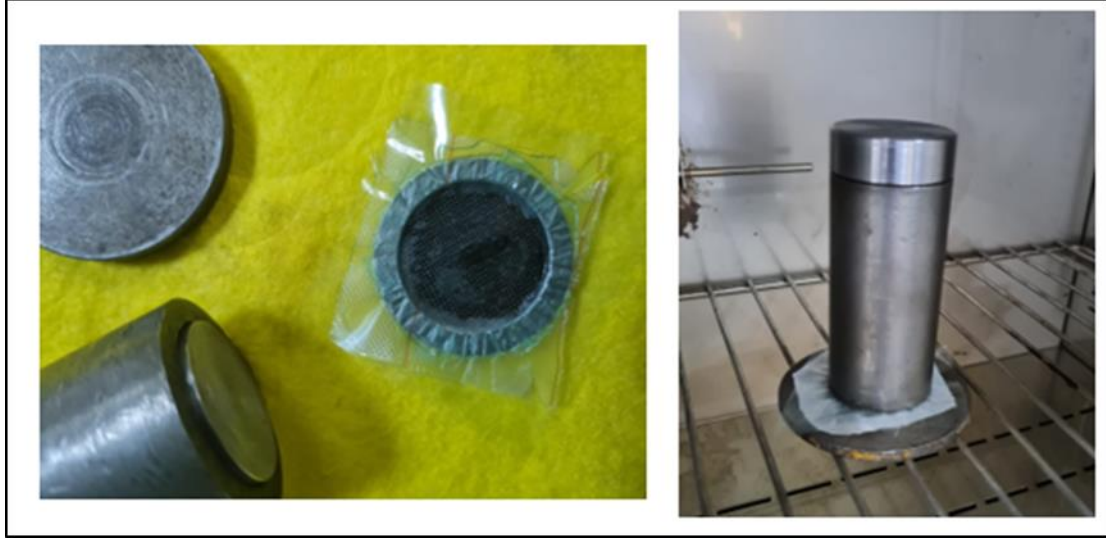
Resim 5.12. Kalıbın parçaları ve etüve yerleştirilmesi.
