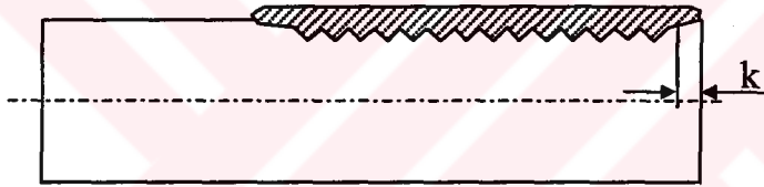
Şekil 4.18 Millerin uç kısımlarının doldurulması [26].
