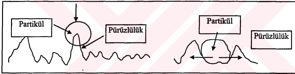
Şekil 4.11 Pürüzlendirilmiş yüzey ile ergimiş partiküllerin etkileşimi [42].
