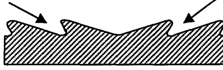
Şekil 4.14 Karşılıklı yönlerde testere dişi vida açarak yüzeylerin hazırlanması [29].
