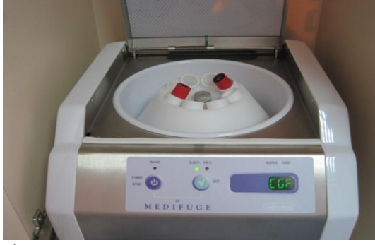
Resim 3.4 a) Kan alınmış tüplerin özel santrifüj cihazına karşılıklı olarak yerleştirilmeleri b) Santrifüj cihazının çalışır durumdaki görüntüsü
