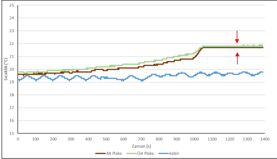
Şekil 9.15. Laird Tflex SF10 numune 0.5 mm kalınlık 1Nm uygulama kuvveti
