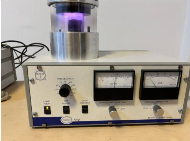
Resim 8.3. Deneysel Çalışmalarda Kullanılan Numunelerin Au/Pd Kaplama Cihazı
