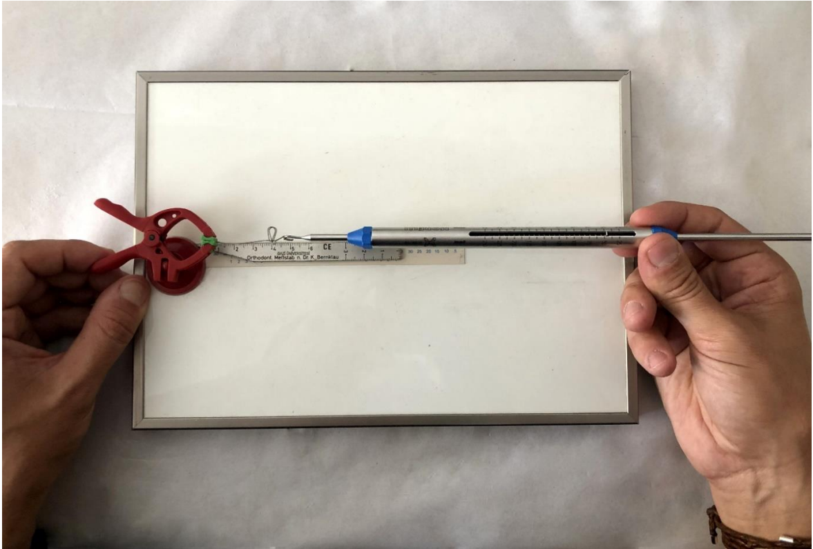
Resim 3.5. PG retraksiyon zembereğinin aktivasyon öncesi oluşturduğu kuvvetin ölçülme şekli
