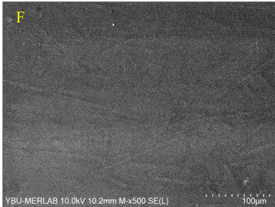
Şekil 4.12. everX Flow (F) herhangi bir işlem uygulanmamış yüzeyi x500 büyütmede SEM görüntüsü
