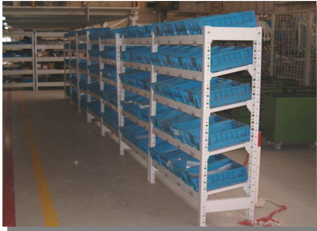
Resim 6.1. e-kanban raflarının görünüşü
