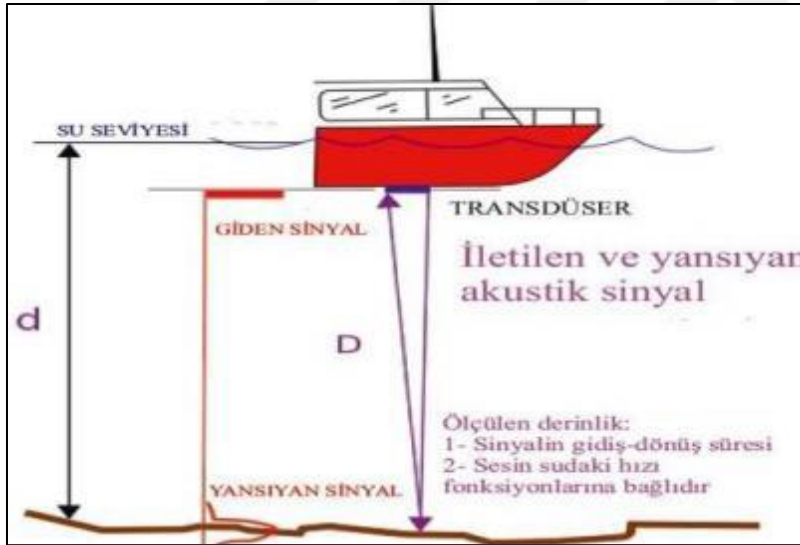
Şekil 3.2. Akustik derinlik ölçümü şematik gösterimi
