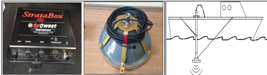
Resim 3.7. Stratabox SBP sistemi prosesor ve 10 Khz transducer ile montaj şekli
