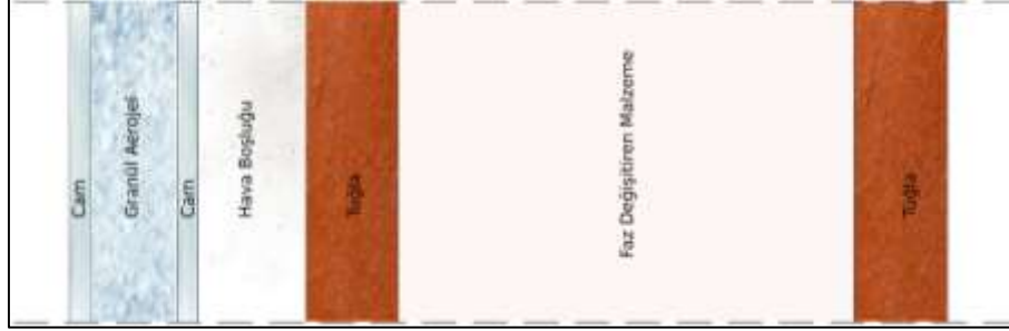
Şekil 3.2. SYM-FDM duvarının kesiti
