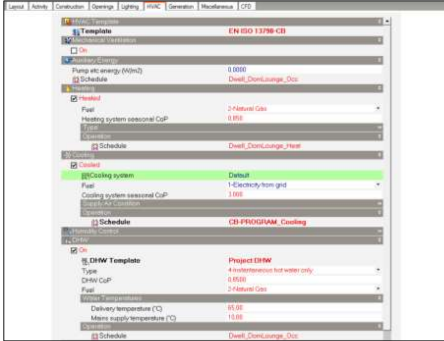
Şekil 3.16. Simülasyonun HVAC ayarları
