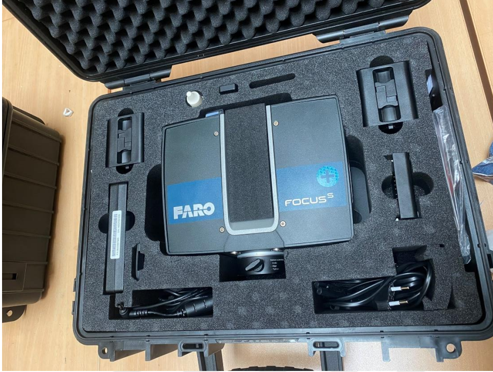
Resim 4.22. FARO FOCUS S+ 150 Lazer Tarama Cihazı
