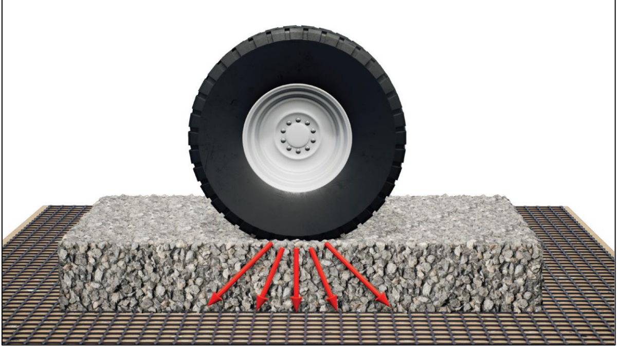
Şekil 2.22. Tekerlek yükünün kaplama tabakasındaki dağılımı (Baselok, 2022)
