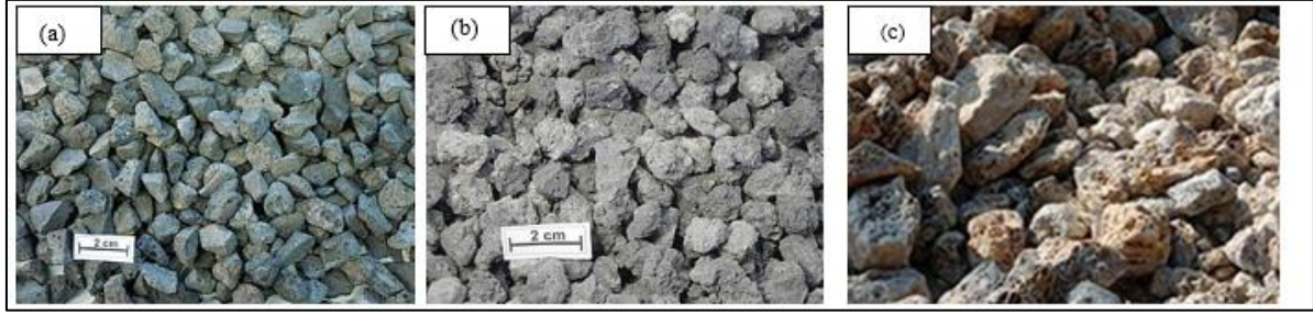
Şekil 2.15. Çelik cürufu türleri a) BOF cürufu b) EAF cürufu c) LF cürufu (Euroslag, 2022)
