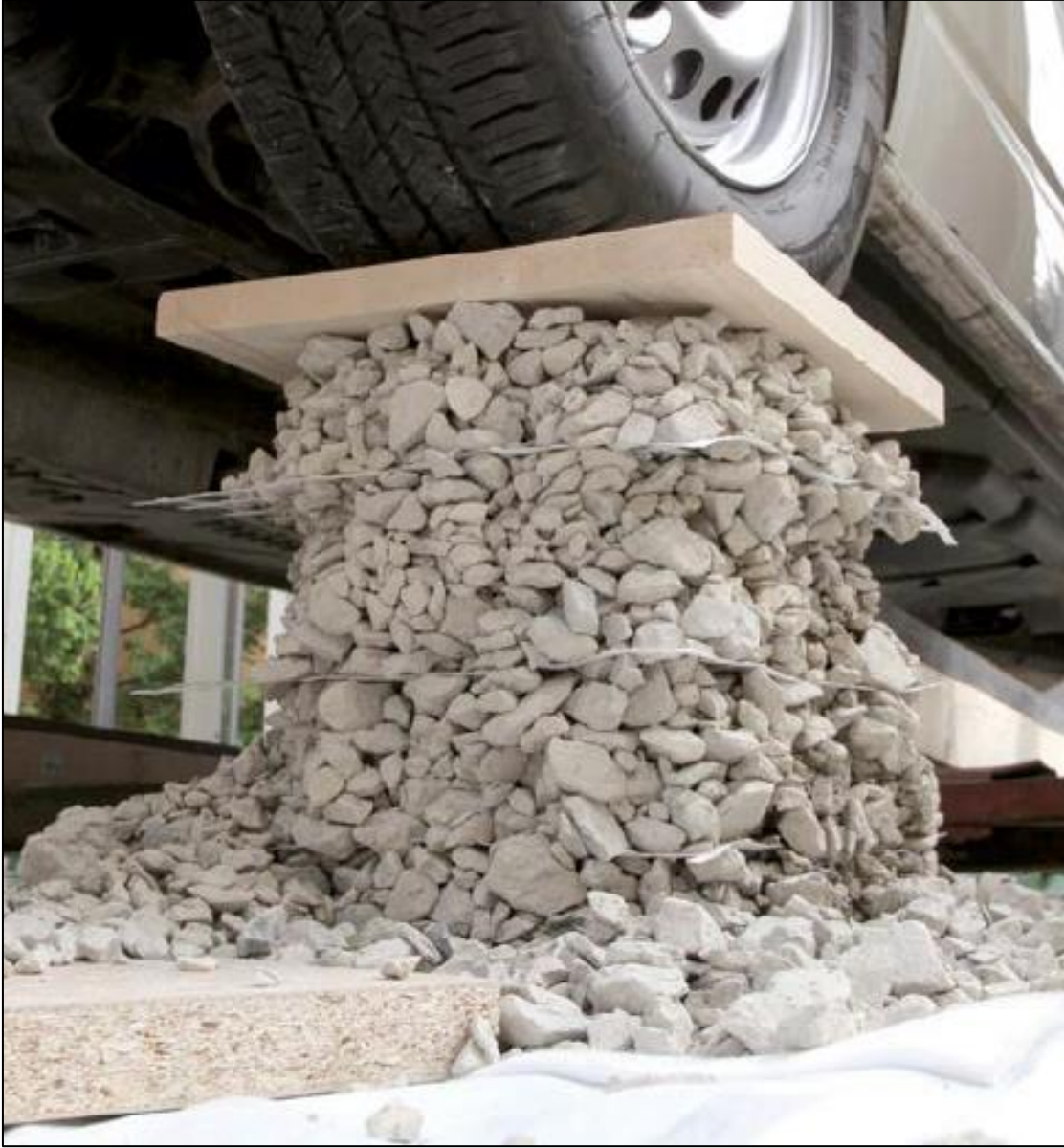
Şekil 2.23. Secugrid® ile güçlendirilmiş çakıl sütun üzerinde duran bir araba ile kilitleme etkisinin gösterilmesi (NAUE, Secugrid)
