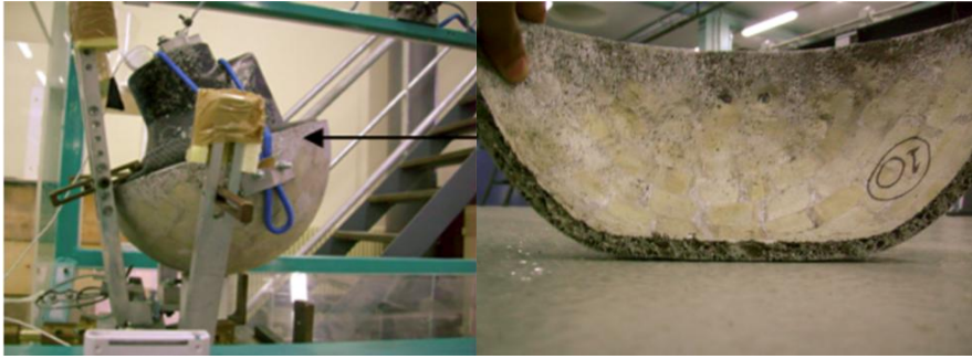
Resim 3.5: Metalik köpük kaskların ön ve üst darbelere karşı test edilmesi (Pinnoji, Mahajan, Bourdet, Deck, Willinger, 2010)
