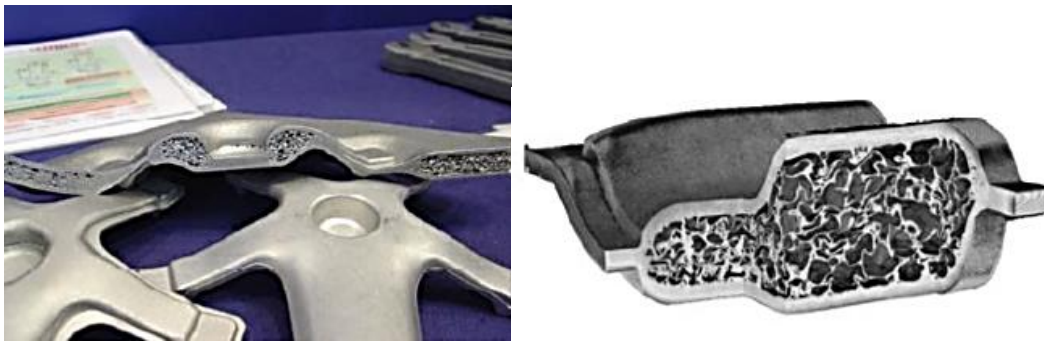
Resim 3.4: Dövme ASK den elde edilen bisiklet krank kolu prototipi (Banhart,Seeliger,2008)
