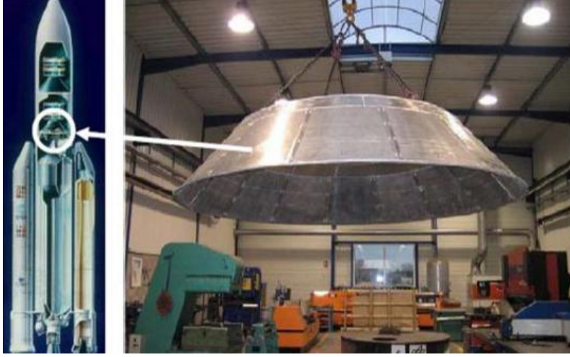
Resim 3.3: Ariane 5 roketinin koni prototipi, soldaki parçanın roketteki konumu (Banhart, Seeliger, 2008)
