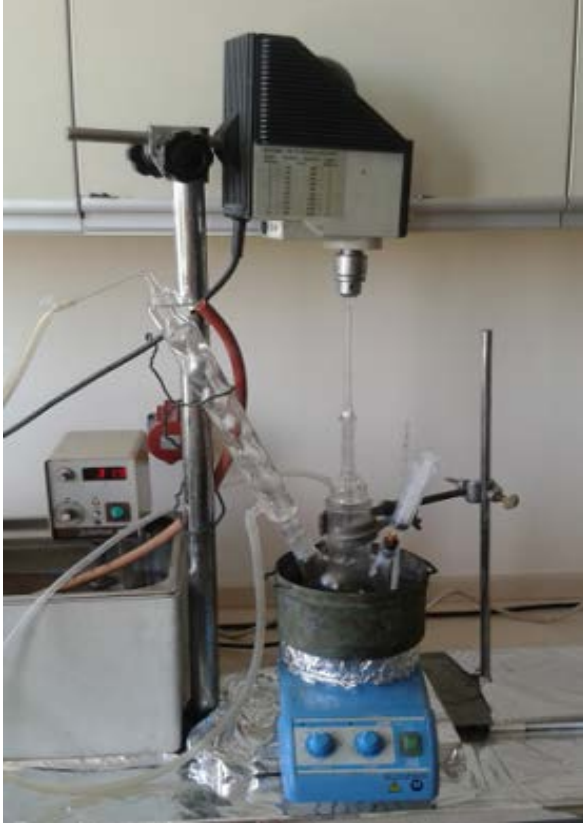
Şekil 3.2. Stiren-divinilbenzen Kopolimerlerinin Sentezinin Gerçekleştiği Deney Sistemi
