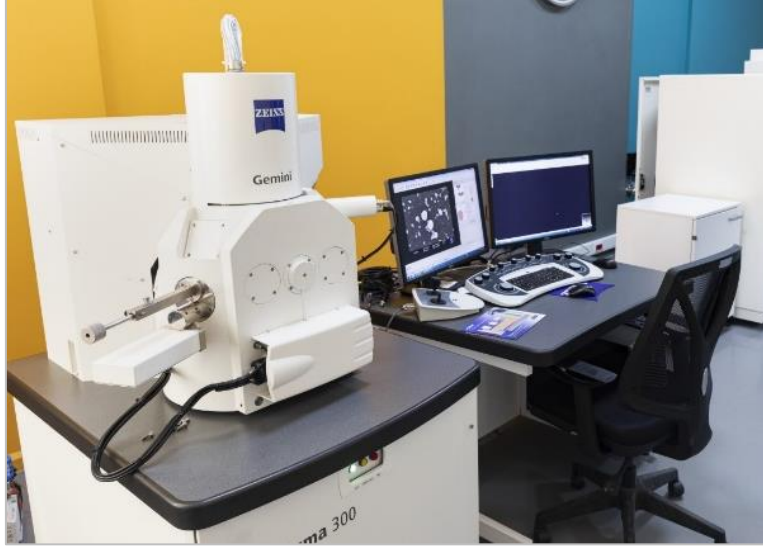
Resim 3.1. Zeiss Sigma 300 SEM cihazı
