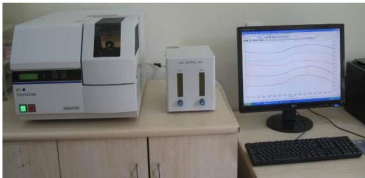
Resim 3.5. Exstar 7300 TG/DTA cihazı
