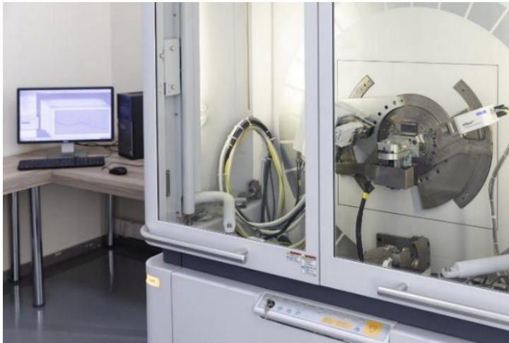
Resim 3.3. PANalytical Empyrean XRD Cihazı
