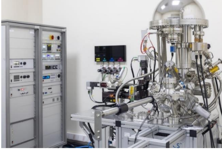
Resim 3.4. Specs-Flex XPS cihazı
