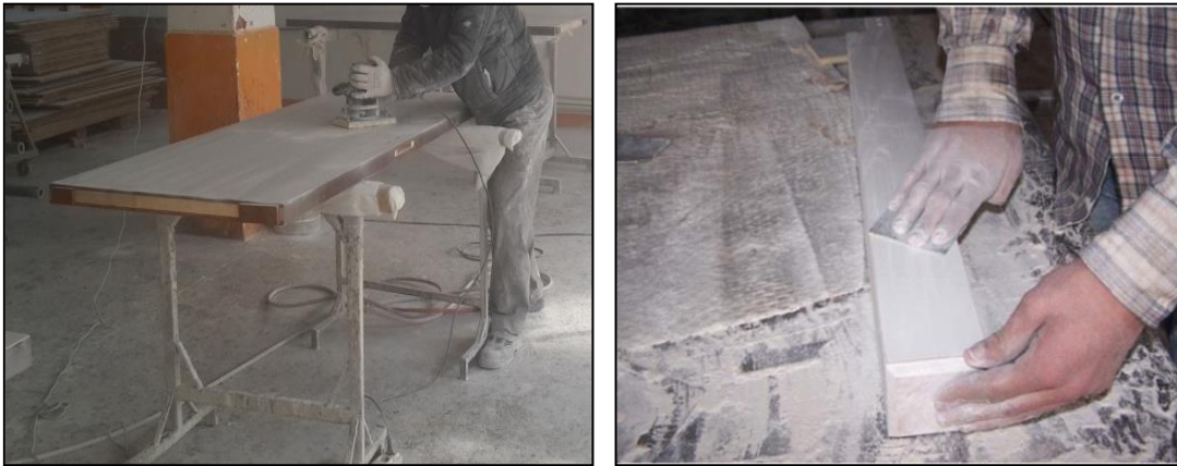
Şekil 2.5. Mobilya atölyelerinde zımpara işlemi ve toz oluşumuna örnekler
