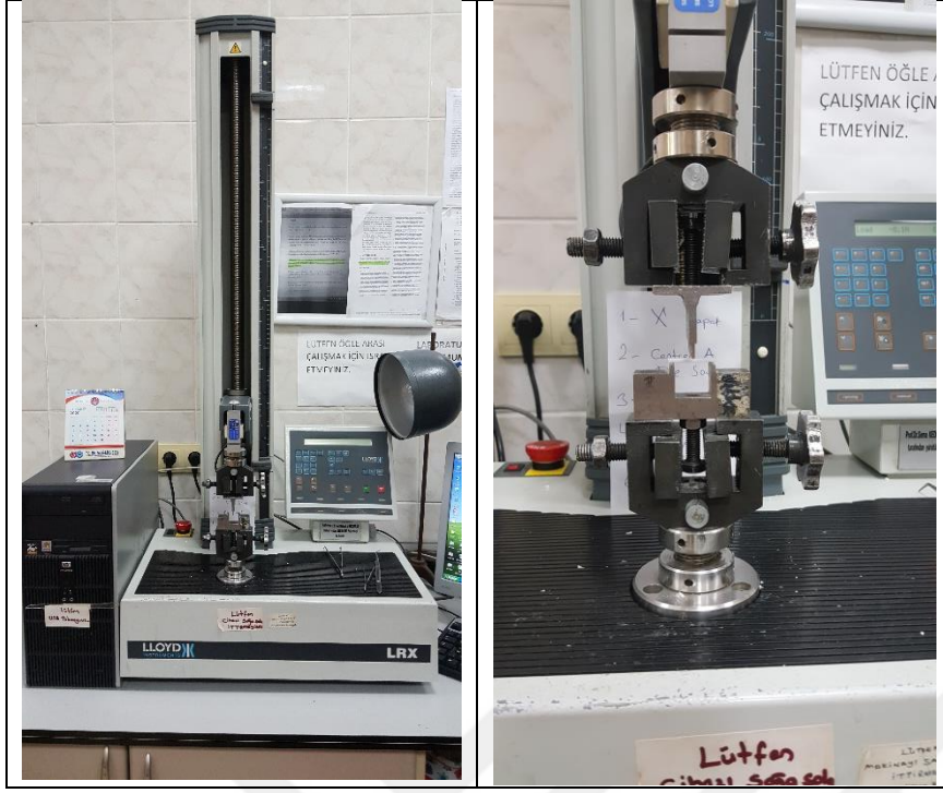
Resim 3.9. Üniversal test cihazı ve testin uygulanması
