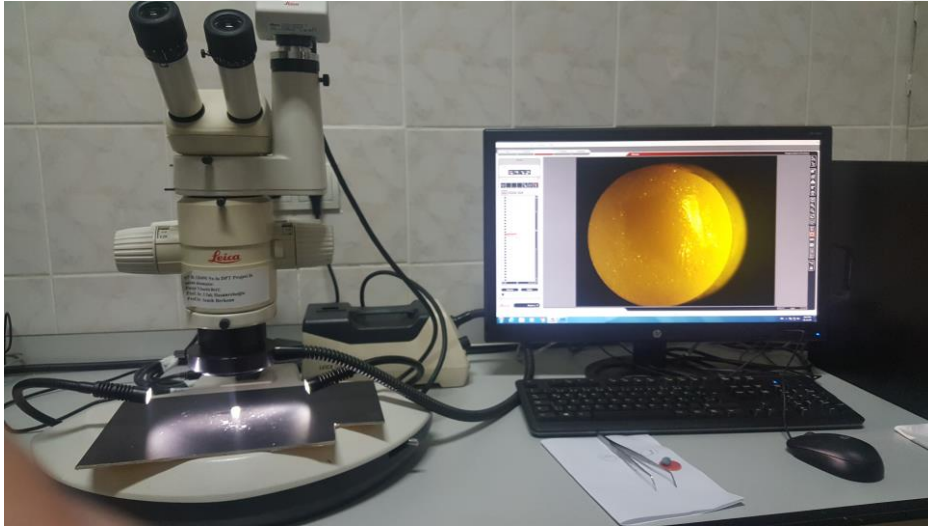
Resim 3.6. Sinterizasyon sonrası örnekler ve testi sonrası kopma yüzeylerinin incelenmesi
