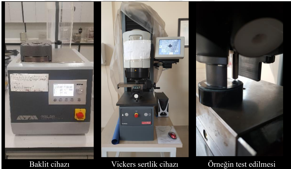
Resim 3.11 Vickers sertlik testinin uygulanması.
