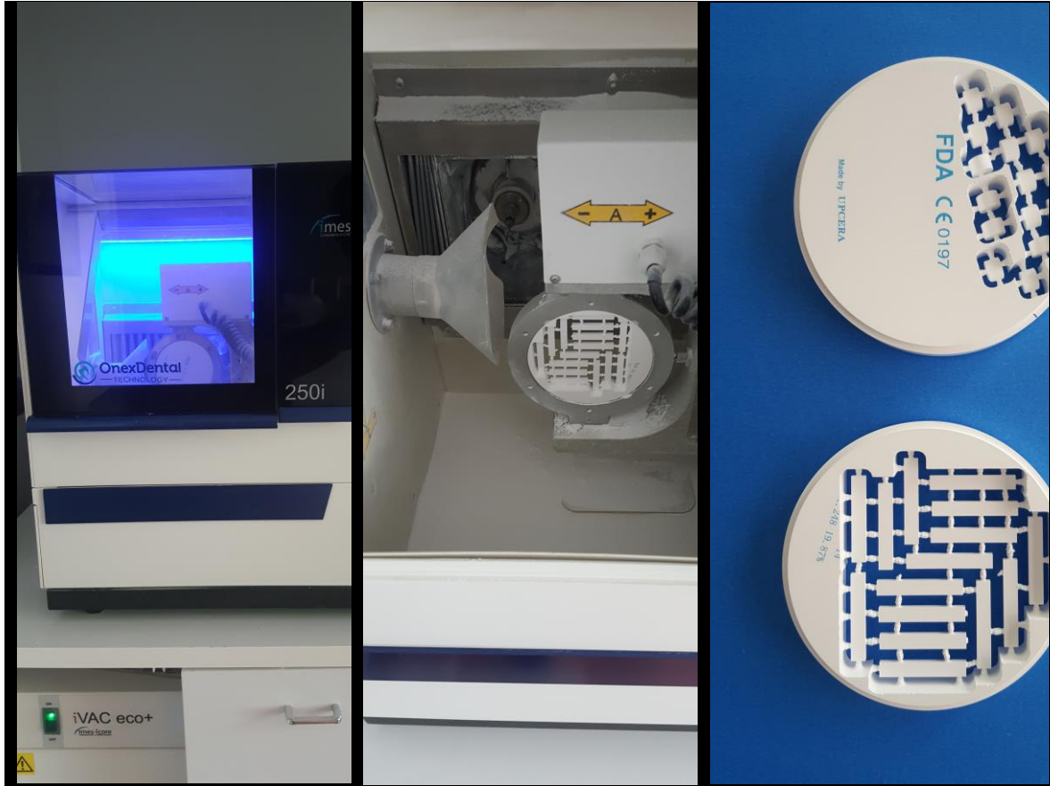
Resim 3.1. Eksiltmeli yöntemle örneklerin hazırlanması
