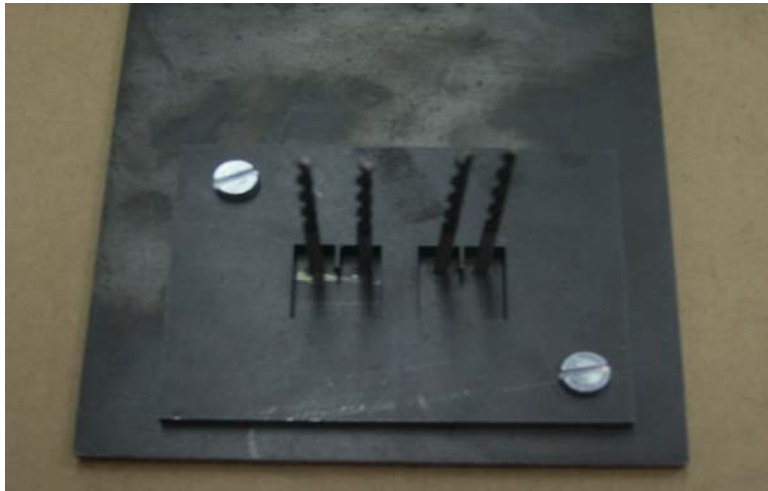
Resim9.Kırılma tokluğu testi için örnek hazırlamakta kullanılan kalıp
