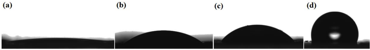
Resim 4.5. (a) Nanotanecik-TiO 2 , (b) nanotanecik-TiO 2 -APTS, (c) nanotanecik-TiO 2 -3TA, (d) nanotanecik-TiO 2 /PEDOT örneklerinin su temas açısı görüntüleri
